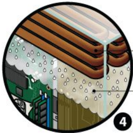
Пар конденсируется на катушках или крышке конденсатора Охлажденная жидкость вновь попадает в "ванну"
