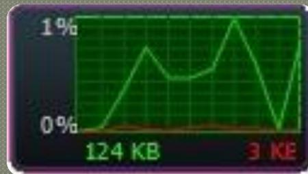
*Network Monitor* (Сетевой монитор) является инструментом, предназначенным для администратора. Утилита *Network Monitor* позволяет перехватывать и анализировать сетевые пакеты, а так же просматривать статистику данных, передаваемых в локальной подсети компьютера, на котором выполняется программа.
