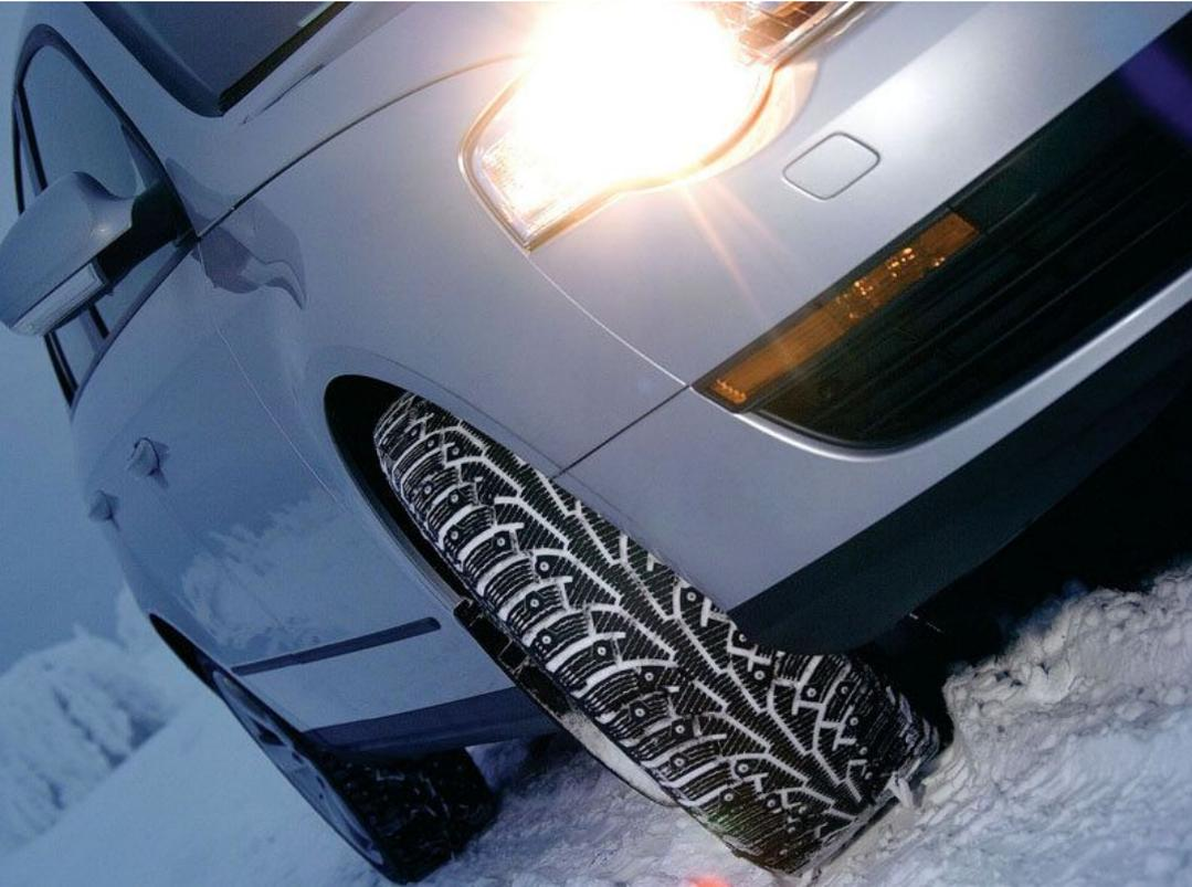
При движении автомобиля в канавки на покрышке вытесняется вода или снег, сцепление с дорогой улучшается.
