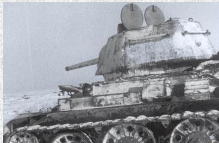
Т-34-76 1942 года выпуска с двумя башенными люками.
