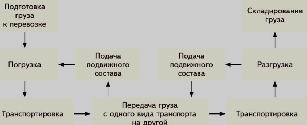
**Рис. 26.** Технологическая схема процесса перевозки груза двумя видами транспорта
