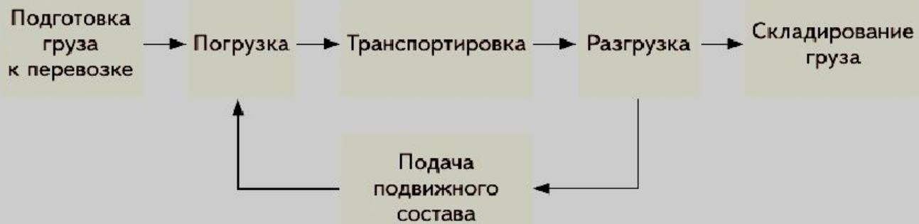
**Рис. 25.** Технологическая схема процесса перевозки груза одним видом транспорта
