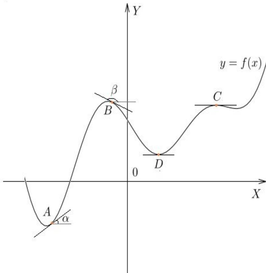
В точке  $A$  функция  $f(x_0)$  возрастает. Касательная к графику, проведенная в точке  $A$ , образует острый угол  $\alpha$  с положительным направлением оси  $X$ . Значит, в точке  $A$  производная положительна.
