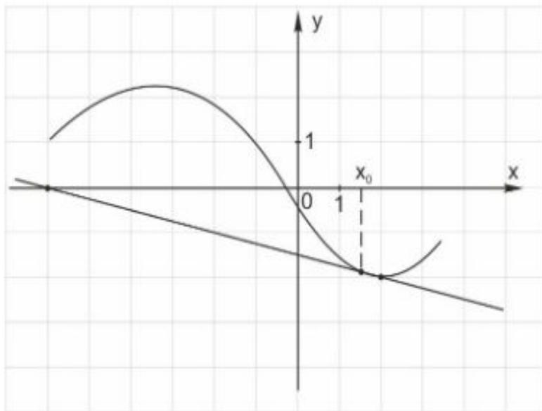
Начнём с определения знака производной. Мы видим, что в точке  $x_0$  функция убывает, следовательно, её производная отрицательна. Касательная в точке  $x_0$  образует тупой угол  $\alpha$  с положительным направлением оси  $X$ . Поэтому из прямоугольного треугольника мы найдём тангенс угла  $\varphi$ , смежного с углом  $\alpha$ .
