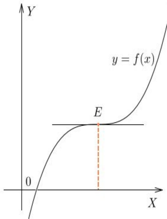
В точке  $E$  касательная к графику горизонтальна, и производная равна нулю. Однако до точки  $E$  функция возрастала – и после точки  $E$  продолжает возрастать. Знак производной не меняется – она как была положительной, так и осталась.
