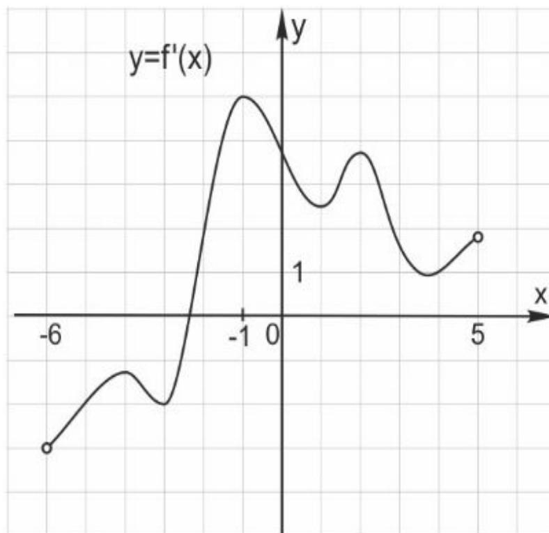
Точками экстремума называют точки максимума и минимума функции. Если производная функции в некоторой точке равна нулю и при переходе через эту точку меняет знак, то это точка экстремума. На отрезке  $[-5; 4]$  график производной (а именно он изображен на рисунке) пересекает ось абсцисс в точке  $x = -2$ . В этой точке производная меняет знак с минуса на плюс.
