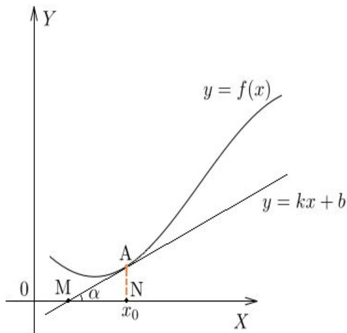
Нарисован график некоторой функции  $y = f(x)$ . Возьмем на нем точку  $A$  с абсциссой  $x_0$ . Проведём в этой точке касательную к графику функции. Мы хотим оценить, насколько круто вверх идет график функции. Удобная величина для этого — *тангенс угла наклона касательной*.
