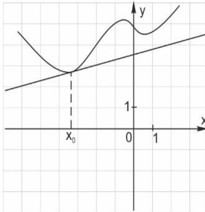
Производная функции  $f(x)$  в точке  $x_0$  равна тангенсу угла наклона касательной, проведенной в точке  $x_0$ .
