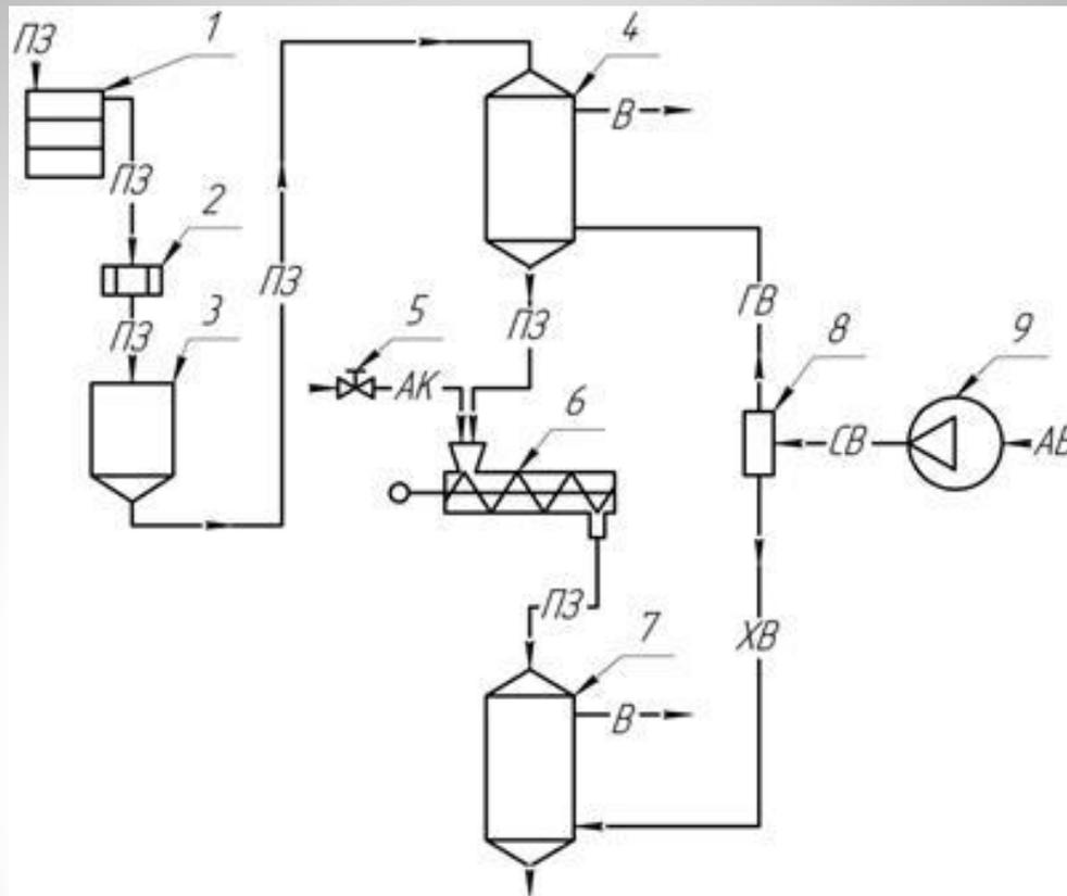
Пшеничные зародыши получают при выработке высоких сортов муки сходом с отсева (1) четвертой размольной системы. Полученный продукт очищают от металломагнитных примесей на магнитном сепараторе (2) и направляют в накопительный бункер (3).
