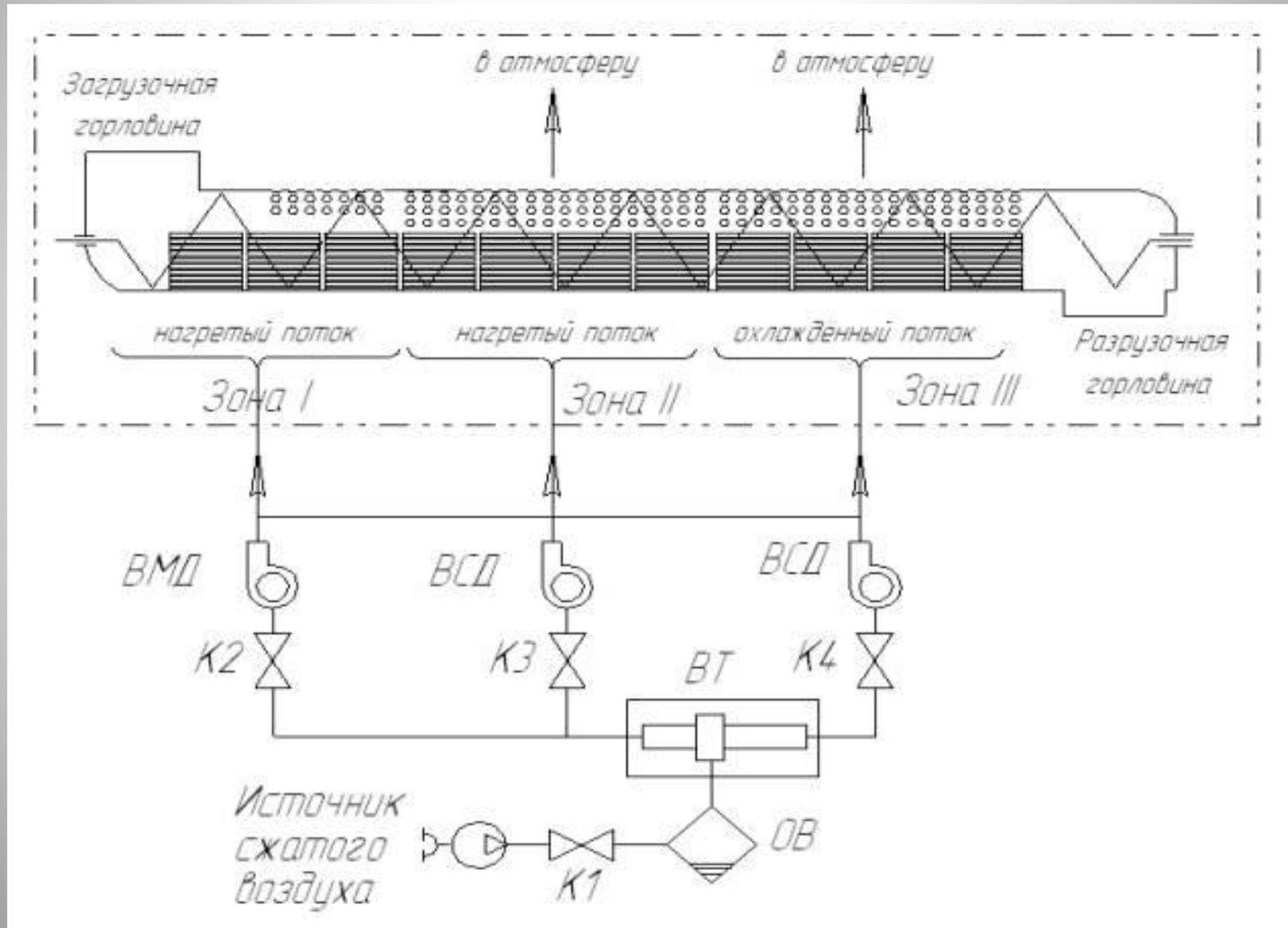
Воздух от источника (компрессор) поступает в осушитель ОВ, а затем в вихревую трубу ВТ, где благодаря процессам энергоразделения формируется нагретый и охлажденный потоки.
