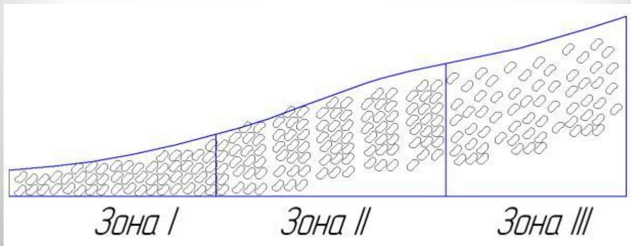
зона I – плотный слой, зона II – разрыхленный слой, зона III – псевдооживленный слой
