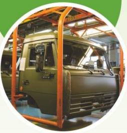
**Обезжиривание** - это удаление жировых загрязнений с поверхности деталей. Обезжиривание производится непосредственно перед нанесением противокоррозионных покрытий.
