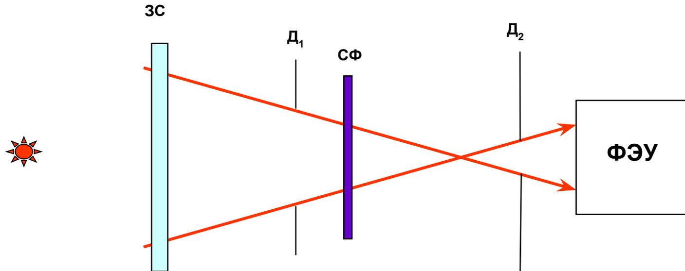
Рис. 6.2.1. Оптическая схема озонметра М-124
