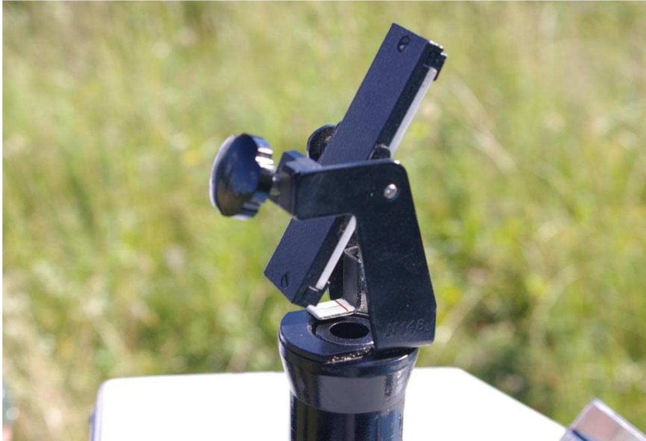
**Отражательный элемент озонметра М-124**
