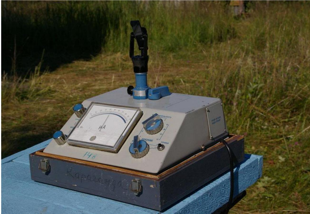
**Озонометр М-124 в рабочем состоянии. Измерение содержания озона по Солнцу в солнечную погоду.**
