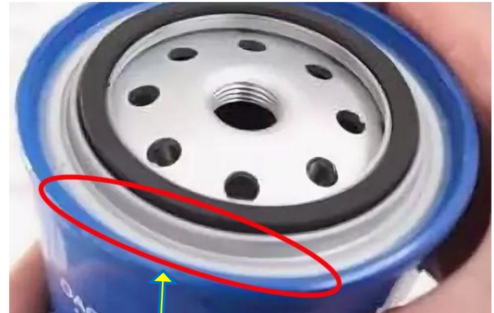
возникновение радиальной трещины
