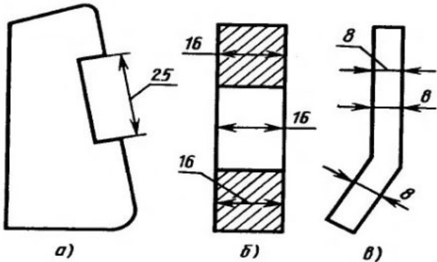
Если наклон размерной линии к вертикали менее  $30^\circ$ , то размерное число наносят на полке линии-выноски (рис. 40, а).
