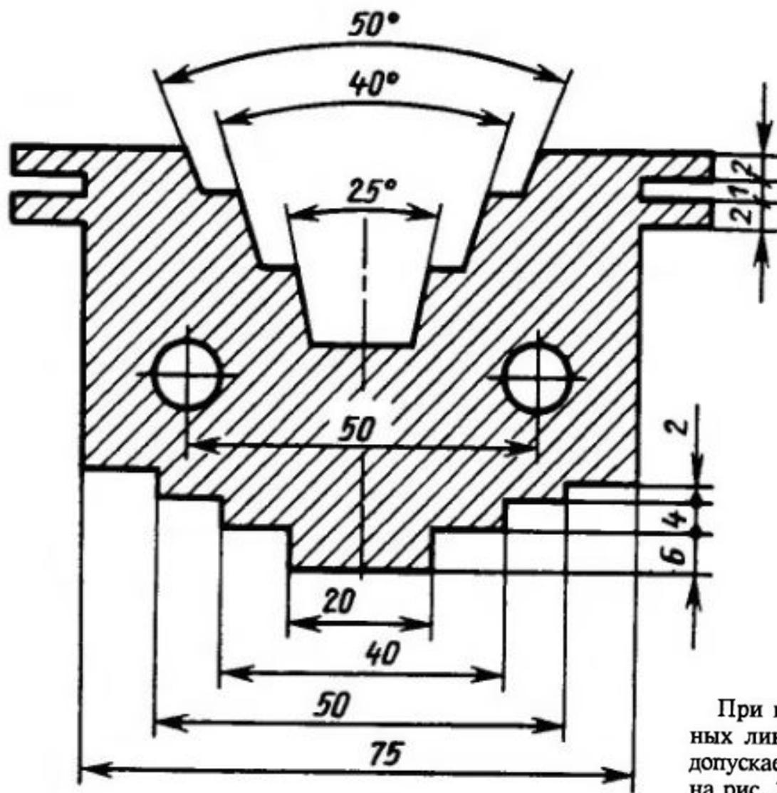
При недостатке места для стрелок на размерных линиях, расположенных цепочкой, стрелки допускается заменять засечками (размеры 2; 1; 2 на рис. 38), наносимыми под углом  $45^\circ$  к размерным линиям, или точками (размеры 6; 4; 2 на рис. 38). В местах нанесения размерного числа осевые, центровые линии и линии штриховки прерывают (размер 50 на рис. 38).
