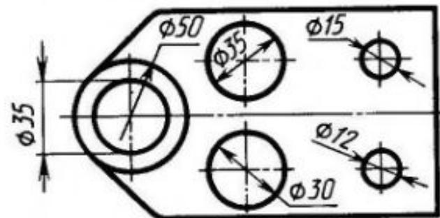
При указании размера диаметра окружности размерную линию можно проводить с обрывом, при этом обрыв размерной линии следует делать несколько дальше центра окружности ( $\text{Ø}50$  на рис. 41, б).
