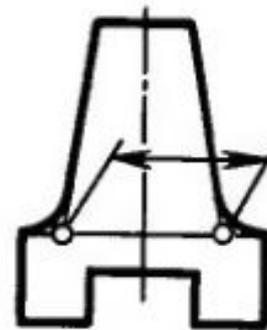
При изображении изделия с разрывом размерную линию не прерывают и наносят действительный размер (рис. 39, а). Если стрелки размерных линий пересекают расположенные близко друг к другу контурные линии, то эти линии рекомендуется прерывать (рис. 39, б). В случае, показанном на рисунке 39, в, размерную и выносные линии проводят так, чтобы они вместе с измеряемым отрезком образовали параллелограмм.
