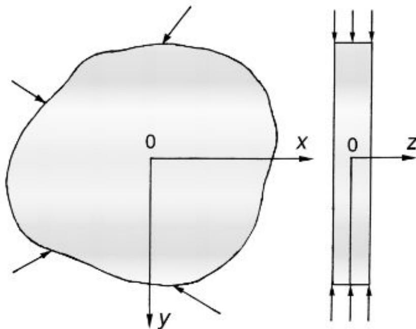
Рис. 2.2. Тонкая пластинка и приложенные к ней нагрузки
