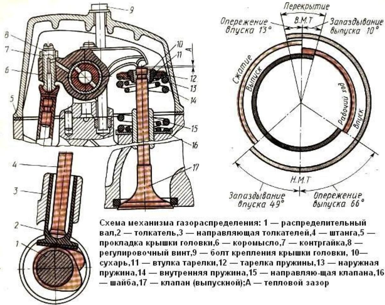
Фазы газораспределения изображаются в виде круговых диаграмм . Из диаграммы видно, что при работе двигателя возникают положения, при которых одновременно открыты впускные и выпускные клапаны; такое состояние называется перекрытием клапанов. Для рассматриваемого двигателя оно составляет  $23^\circ$  при положений поршня у ВМТ и  $115^\circ$  при положении поршня у НМТ.
