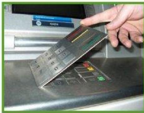
или на клавиатуру приклеивают накладку, очень похожую на настоящую клавиатуру, которая запоминает нажатия клавиш и также записывает их на
