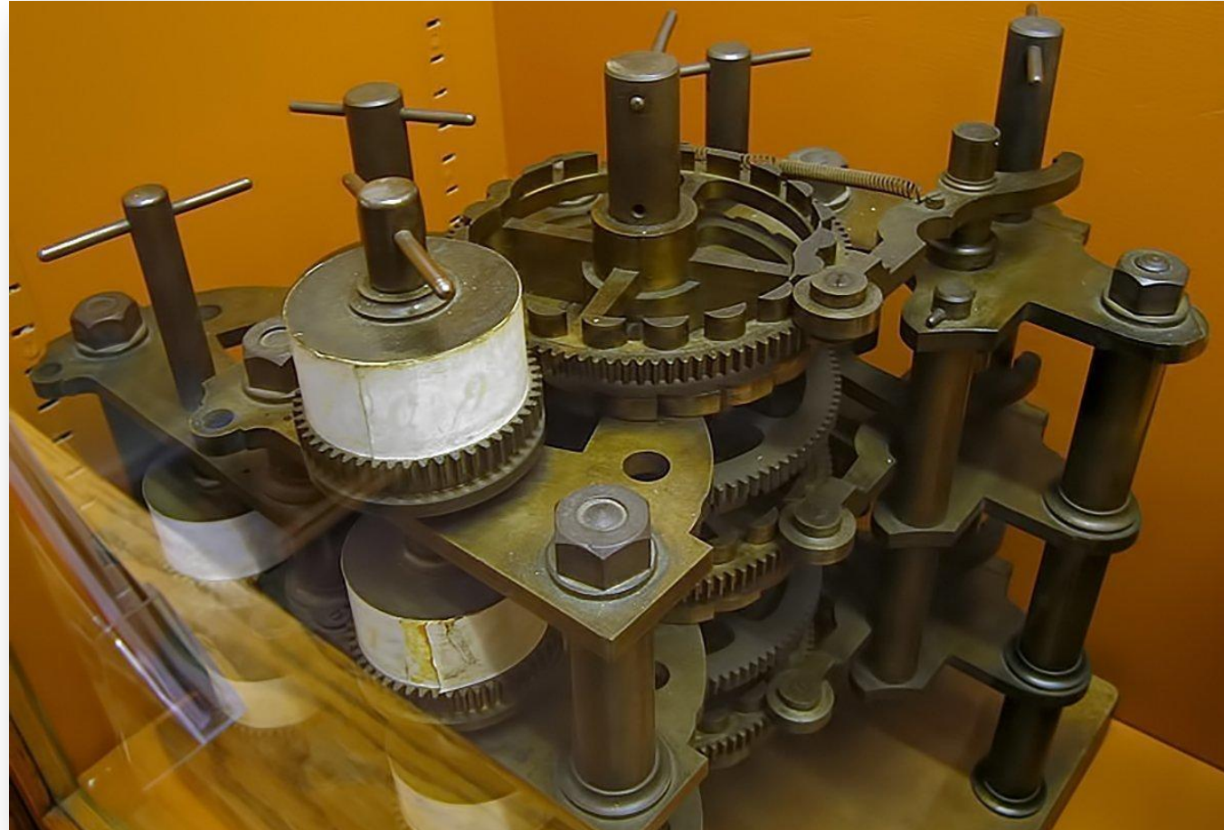
Фрагмент разностной машины Чарльза Бэббиджа, собранный его сыном из деталей, найденных в лаборатории отца. Металлические шестерни выполняют математические операции
