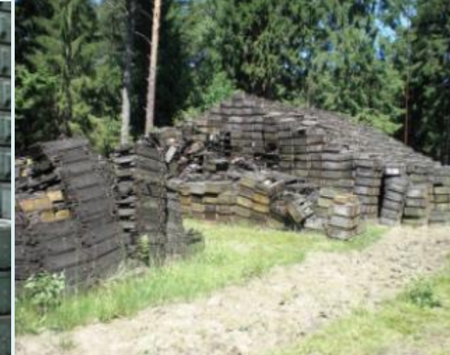
Нарушена устойчивость штабелей на 14-ти открытых площадках
