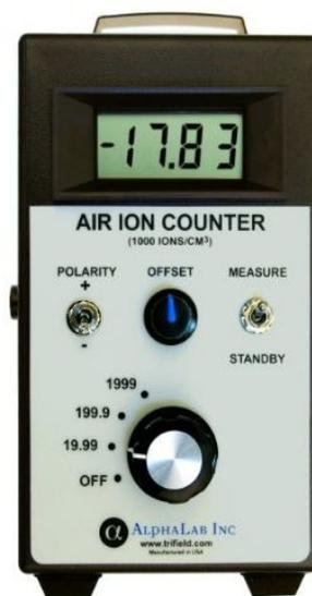
**Счетчик ионов AIC (Air Ion Counter)** считает количество положительных и отрицательных ионов в воздухе, в кубическом сантиметре. Диапазоны измерений: до 2 млн. ионов/ до 20 млн. ионов/ до 200 млн. ионов.
