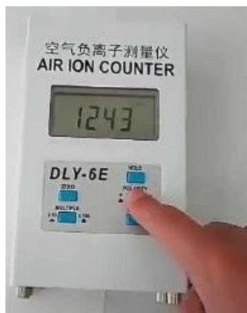
Счетчик ионов воздуха для измерения, диапазон от 10 до 399990 ионов/см<sup>3</sup>
