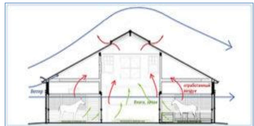
Схема движения воздуха при естественном способе вентилирования
