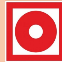
Кнопка включения установок пожарной автоматики
