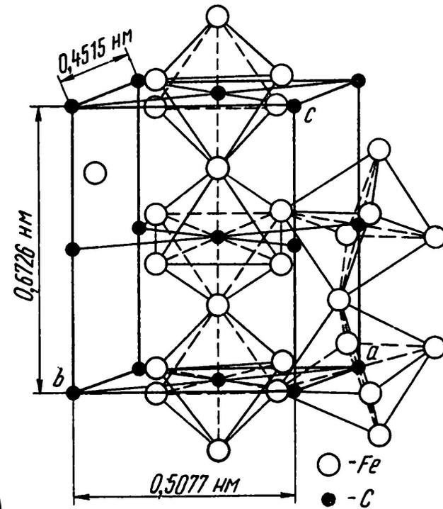
Цементит – метастабильная фаза, в сплавах с высоким содержанием углерода в равновесных условиях распадается с образованием графита (графитизация). Данный процесс важен для высокоуглеродистых сплавов – чугунов. В этом случае вместо диаграммы состояния железо – цементит (метастабильное равновесие) рассматривается диаграмма железо – графит (стабильное равновесие)
