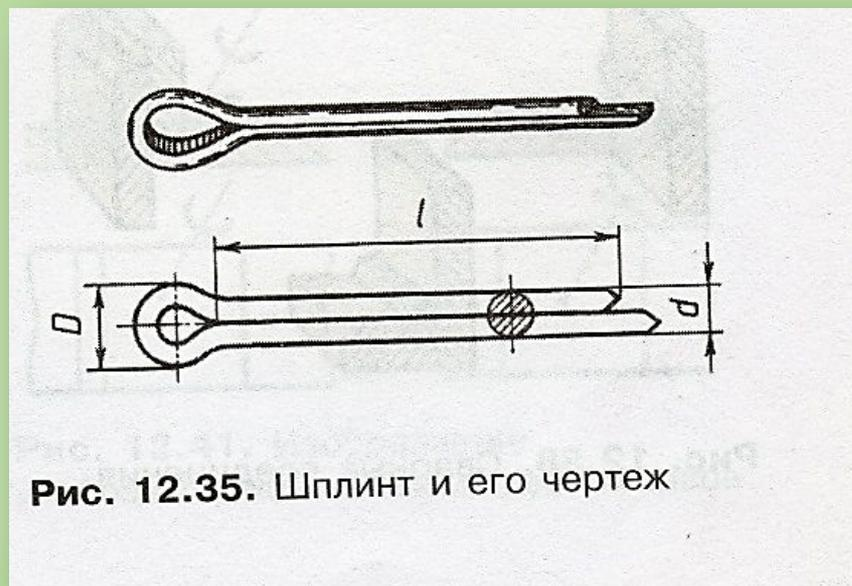
Рис. 12.35. Шплинт и его чертеж
