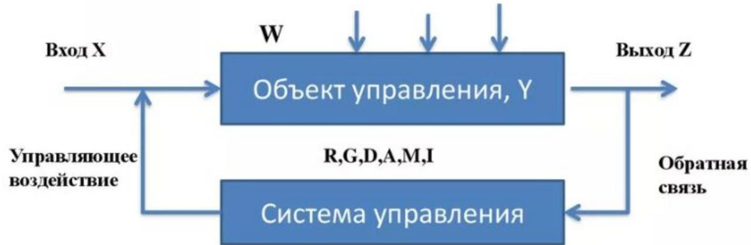
Реализует алгоритм жесткого управления и алгоритм корректирующего воздействия
