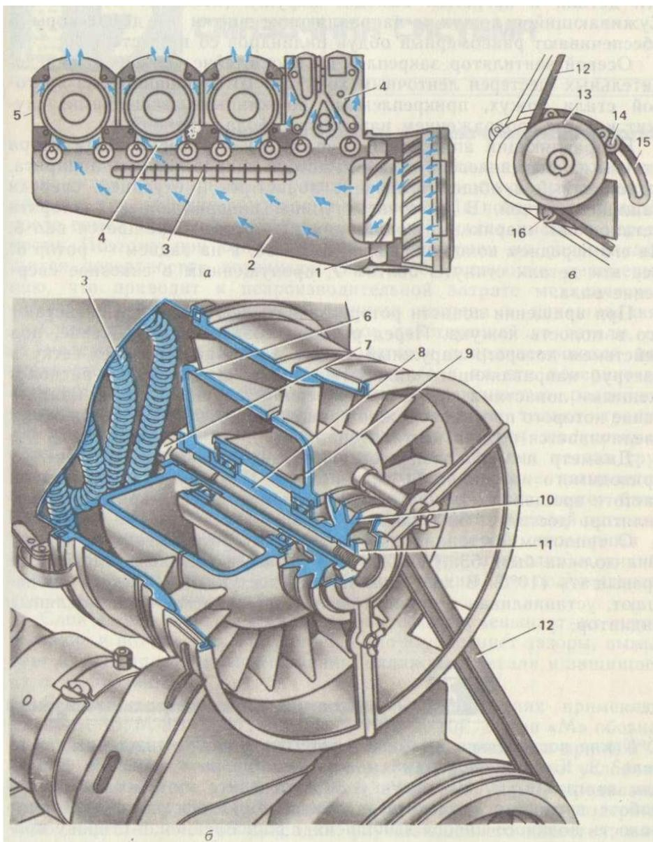
Рис. 42. Система охлаждения двигателя Д-144:
