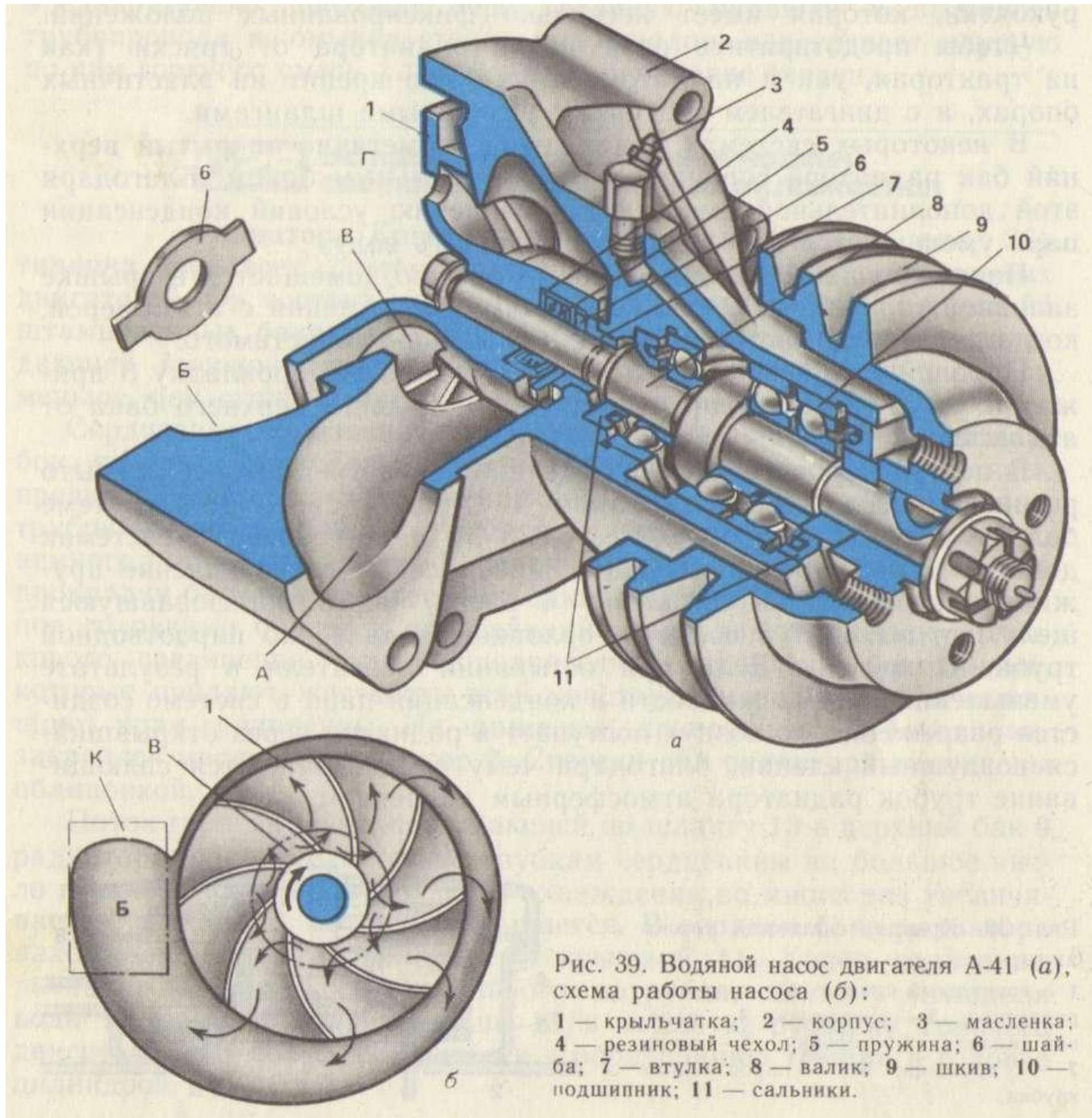
Рис. 39. Водяной насос двигателя А-41 (а),
