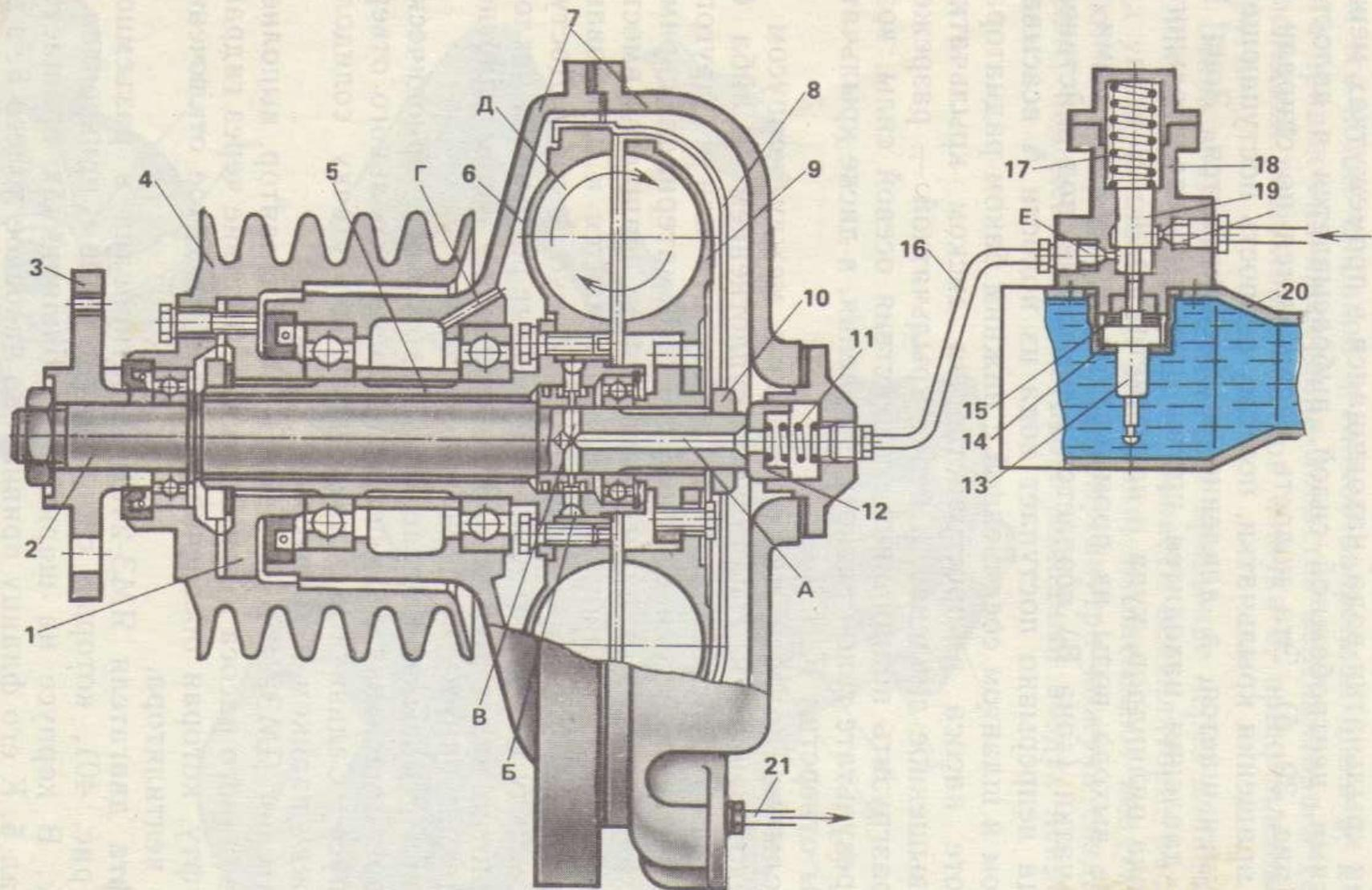
Рис. 40. Привод вентилятора двигателя ЯМЗ-240Б:
