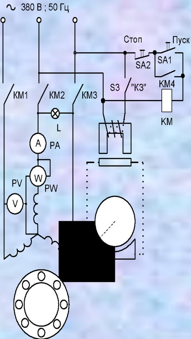
Рис 2.1 Электрическая схема для испытания асинхронного двигателя с короткозамкнутым ротором в режимах холостого хода и короткого замыкания
