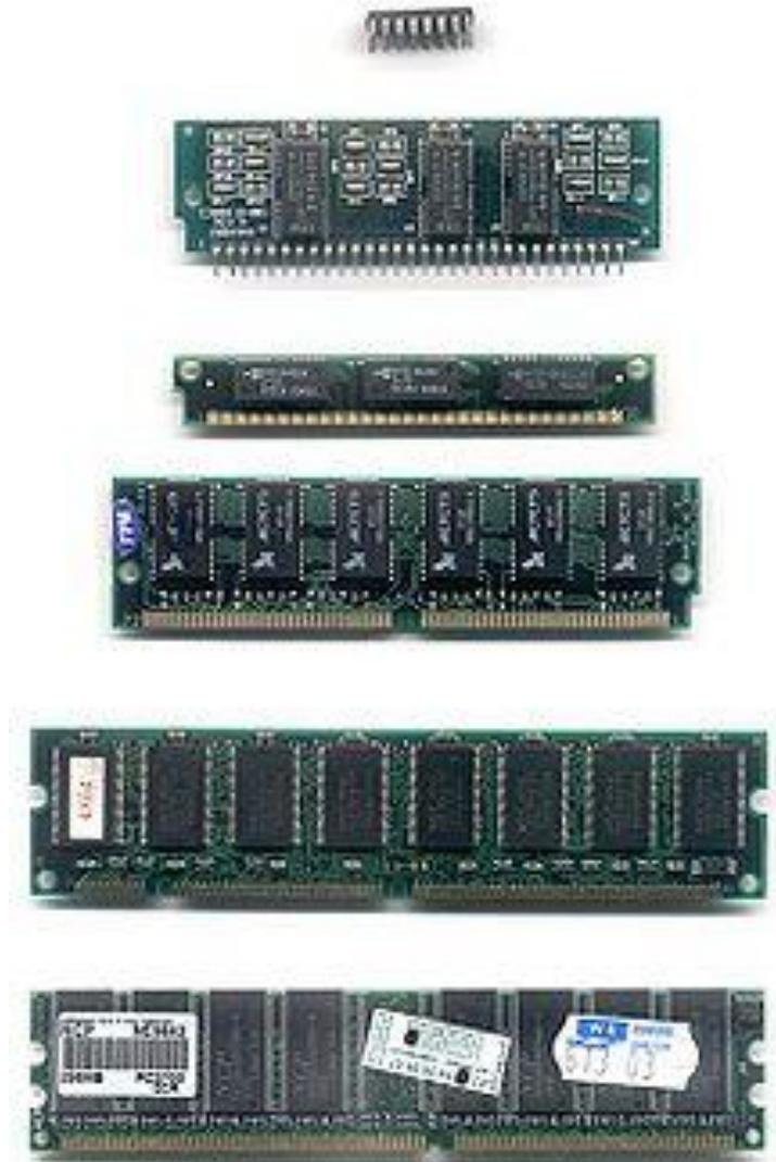
Эволюционное развитие конструкции модулей памяти, используемые в качестве ОЗУ компьютера. Сверху вниз: [DIP](#), SIPP, [SIMM](#) SIPP, SIMM 30 pin, SIMM 72 pin, [DIMM](#) SIPP, SIMM 30 pin, SIMM 72 pin, DIMM, [DDR DIMM](#)
