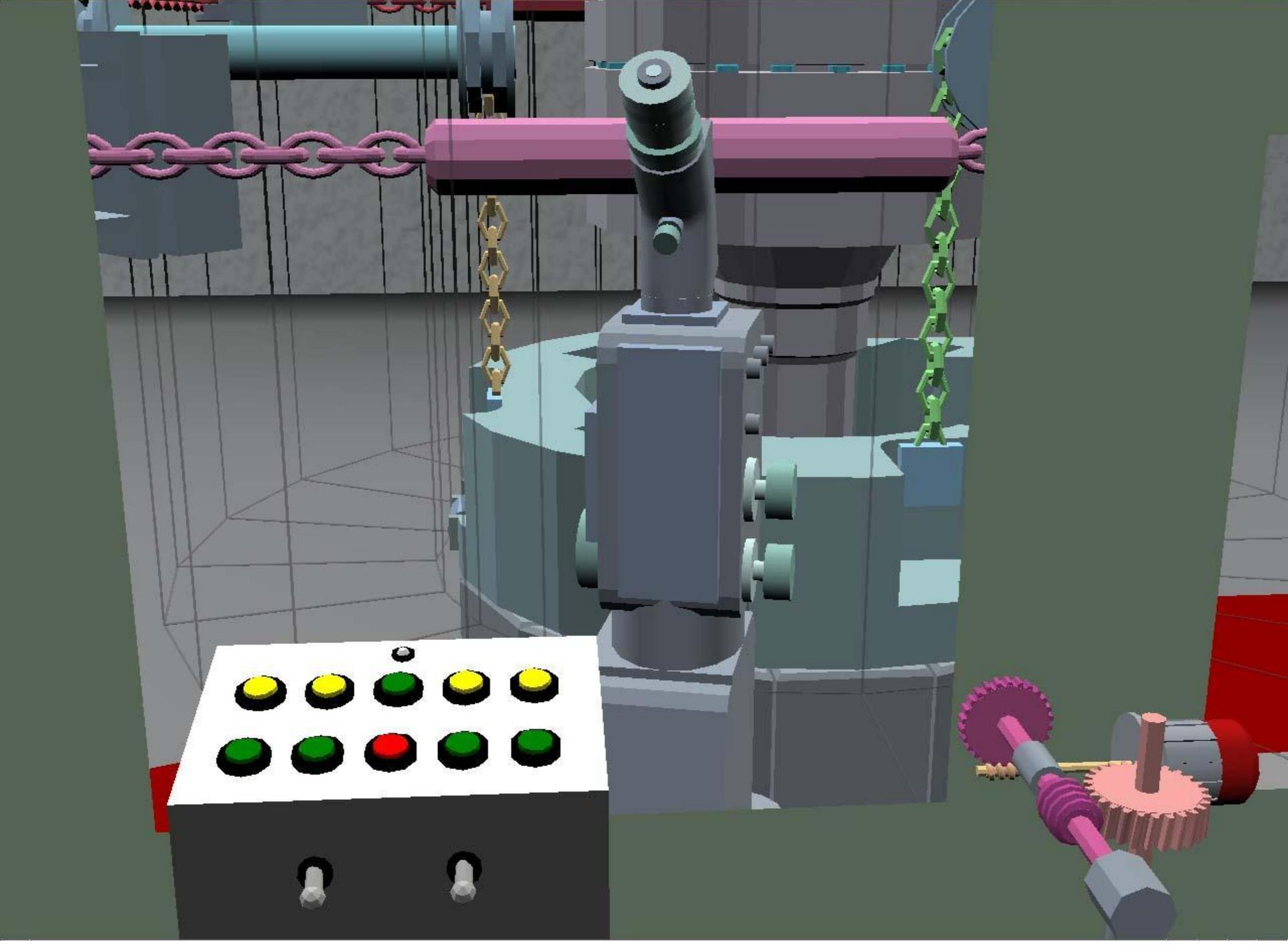
Секция №2 состоит из корпуса с дверью, привода подъема СП и привода герметизации ТК.
