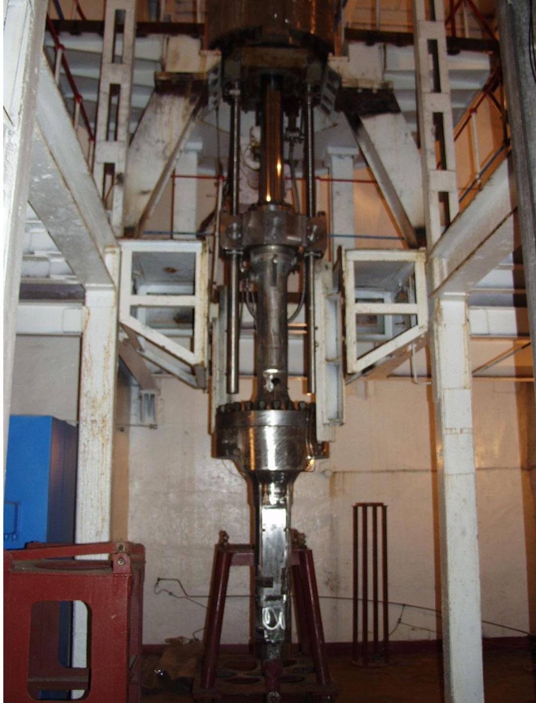
Внутри подвижного корпуса смонтирована коническая передача для приведения во вращение ключа герметизации (КГ) 9. КГ представляет собой трубу с двумя выступами – шлицами (клыками) на нижнем конце.
