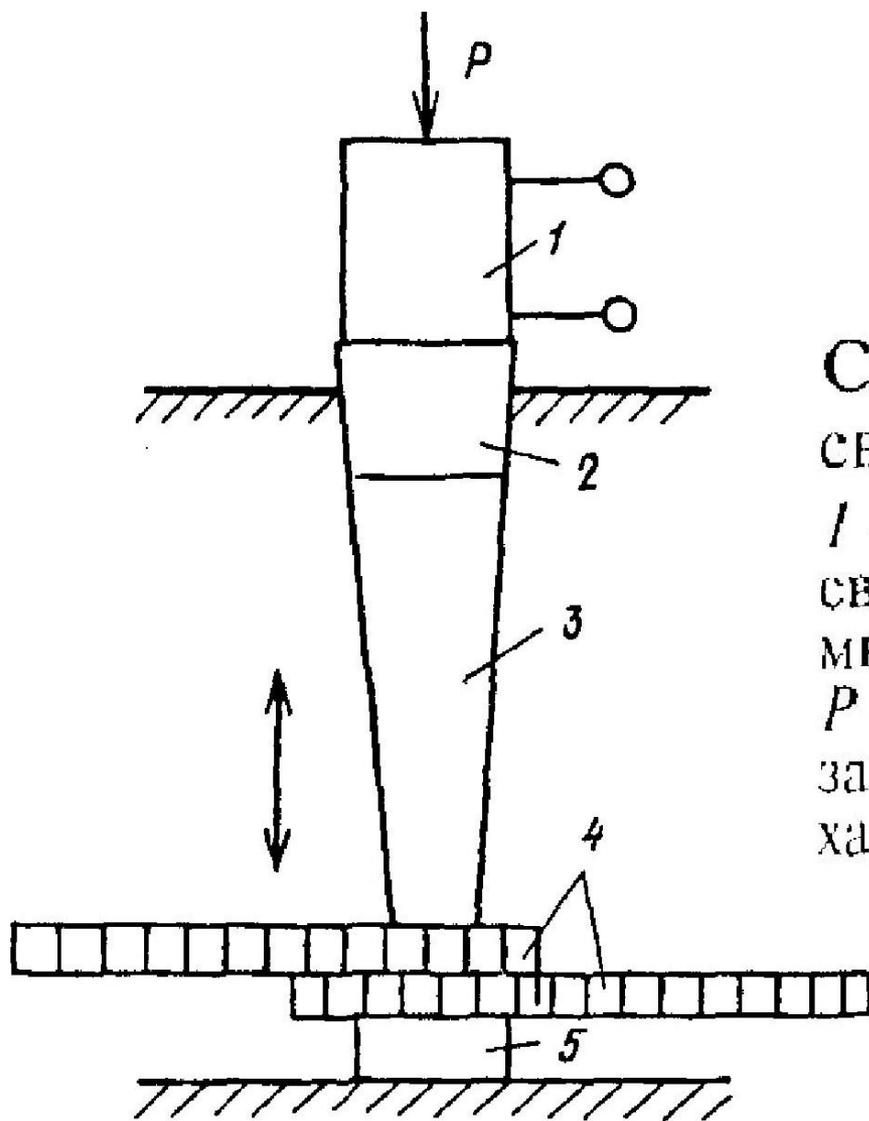
Схема ультразвуковой сварки пластмасс:
