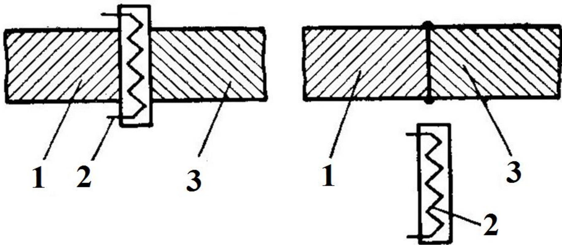
**Схема устройства для термоконтактной сварки
