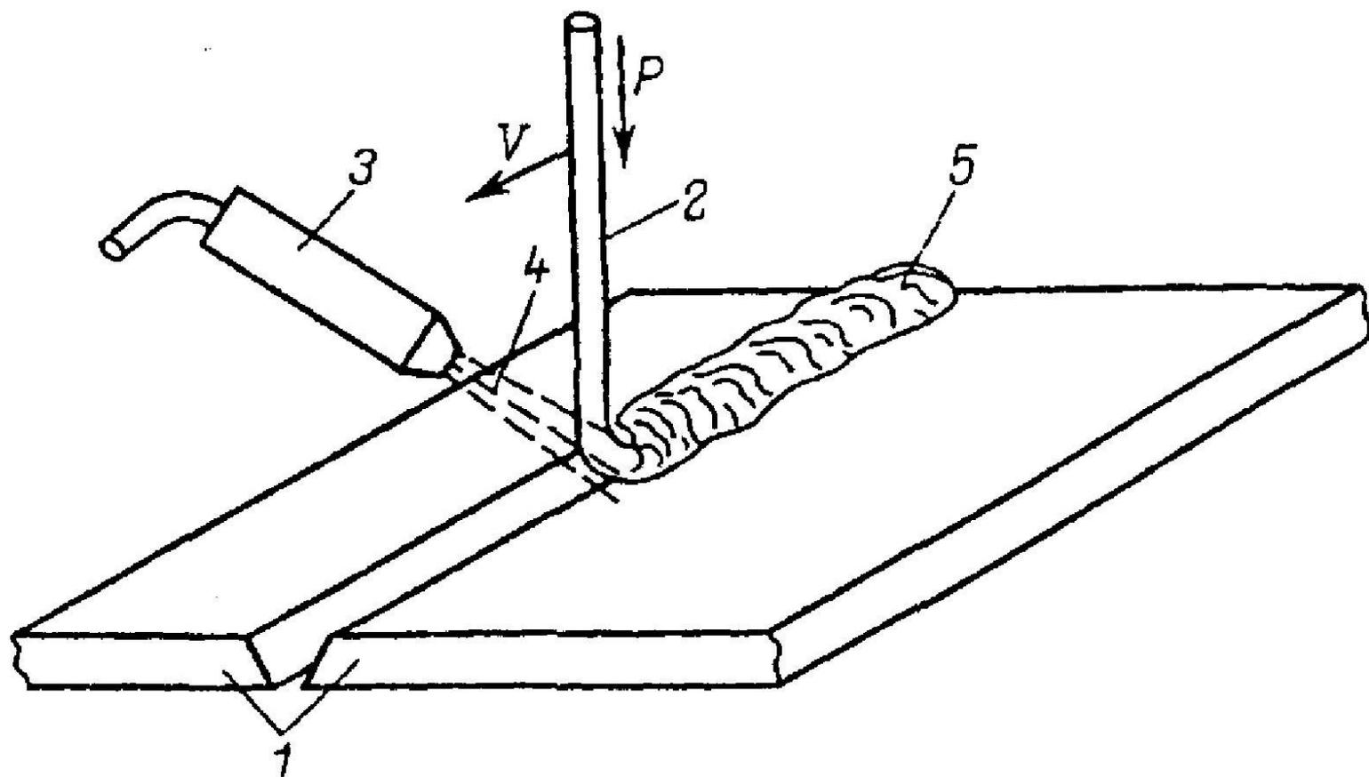
Схема сварки нагретым газом с применением присадочного материала:
