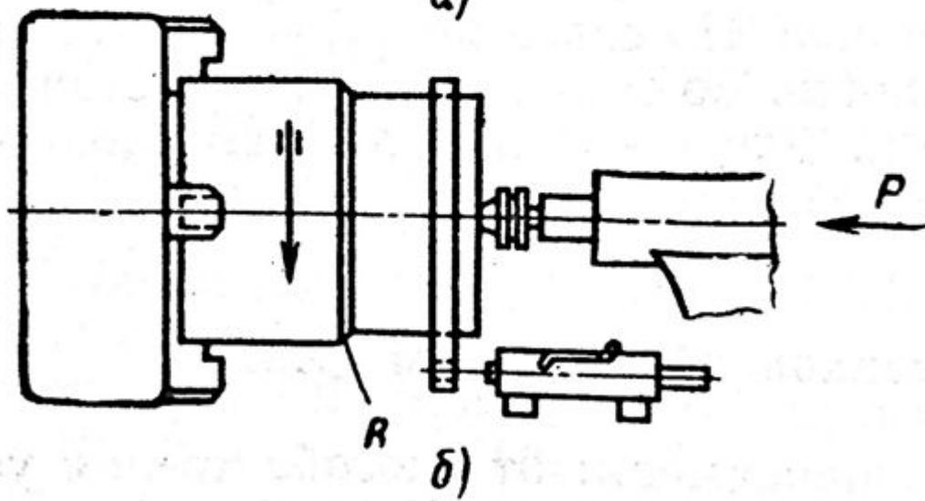
**Схема сварки вращением на токарном станке:**
