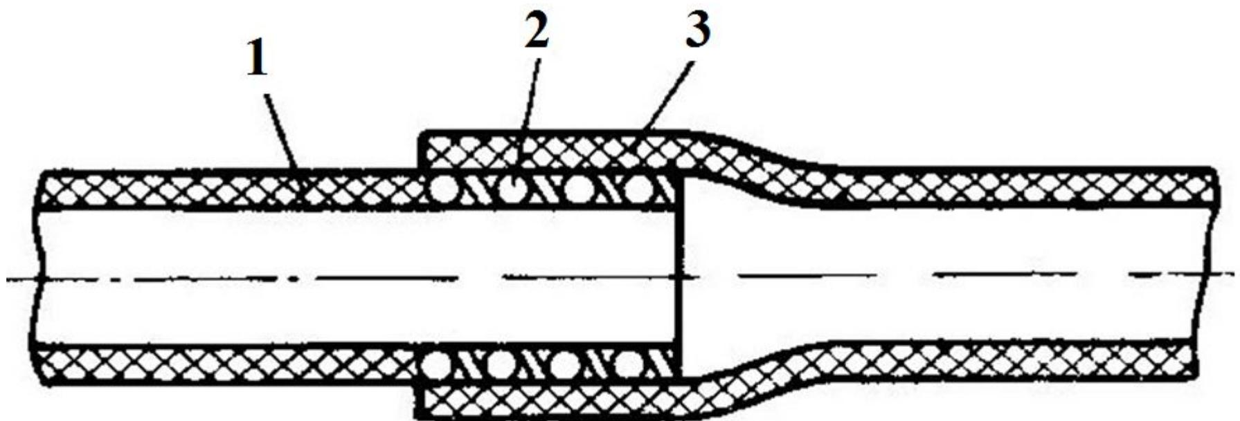
**Схема термоимпульсной сварки труб внахлестку:
