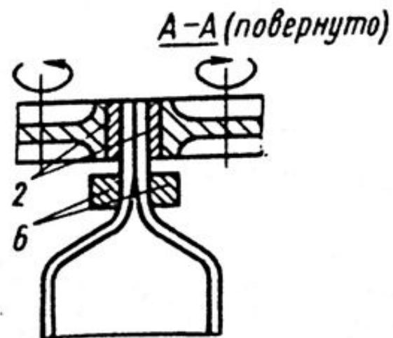
**Схема сварочного узла установки для ленточной контактно-тепловой сварки мешков**
