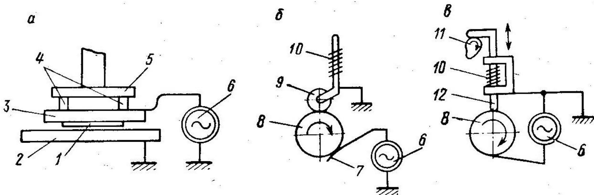
**Схемы машин для высокочастотной сварки:**
