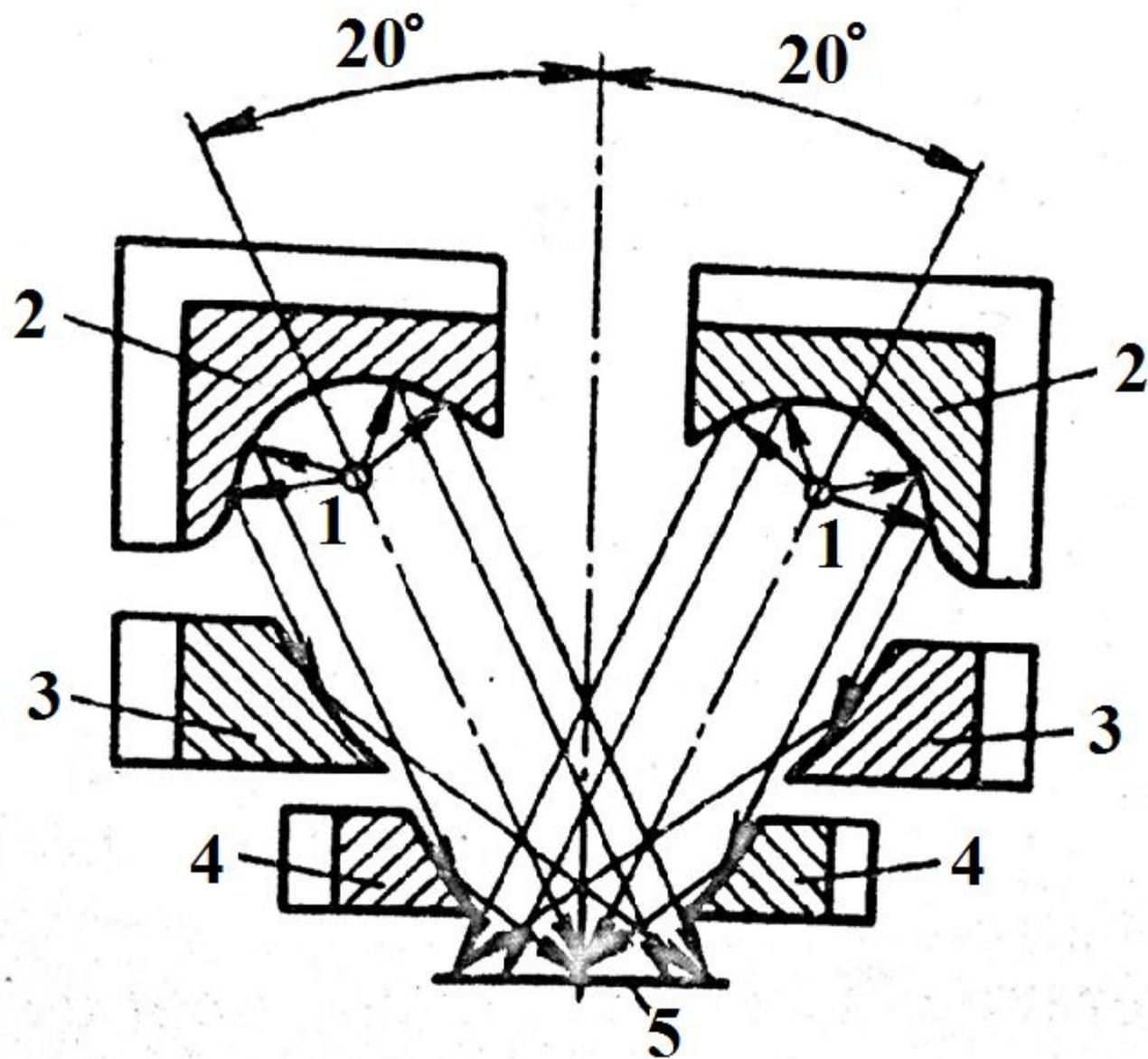
**Схема оптической системы аппарата "Пилад-220" для нагрева свариваемых элементов инфракрасным излучением**
