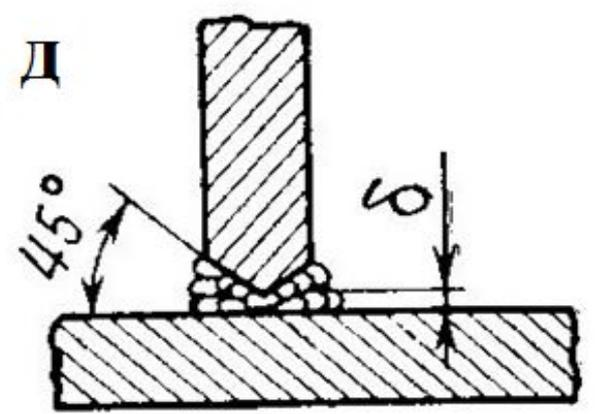
**Схемы сварочных швов для газовой сварки:
