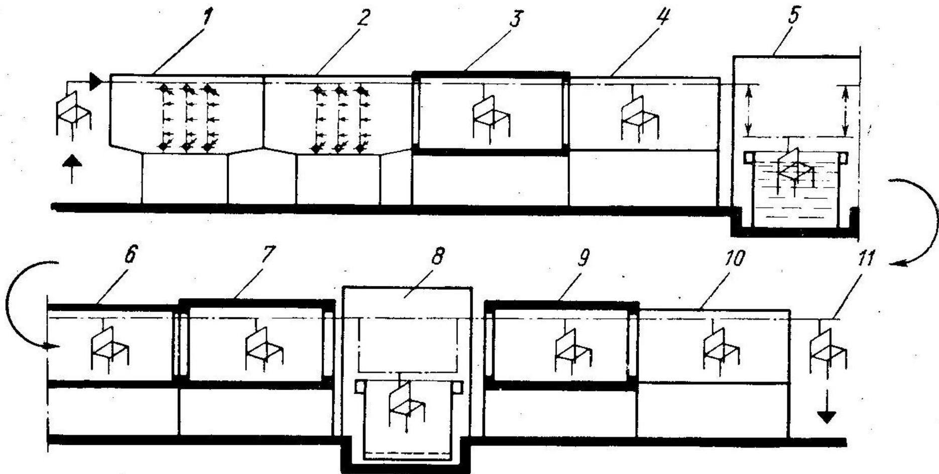
Полуавтоматическая линия для нанесения покрытий вихревым методом:
