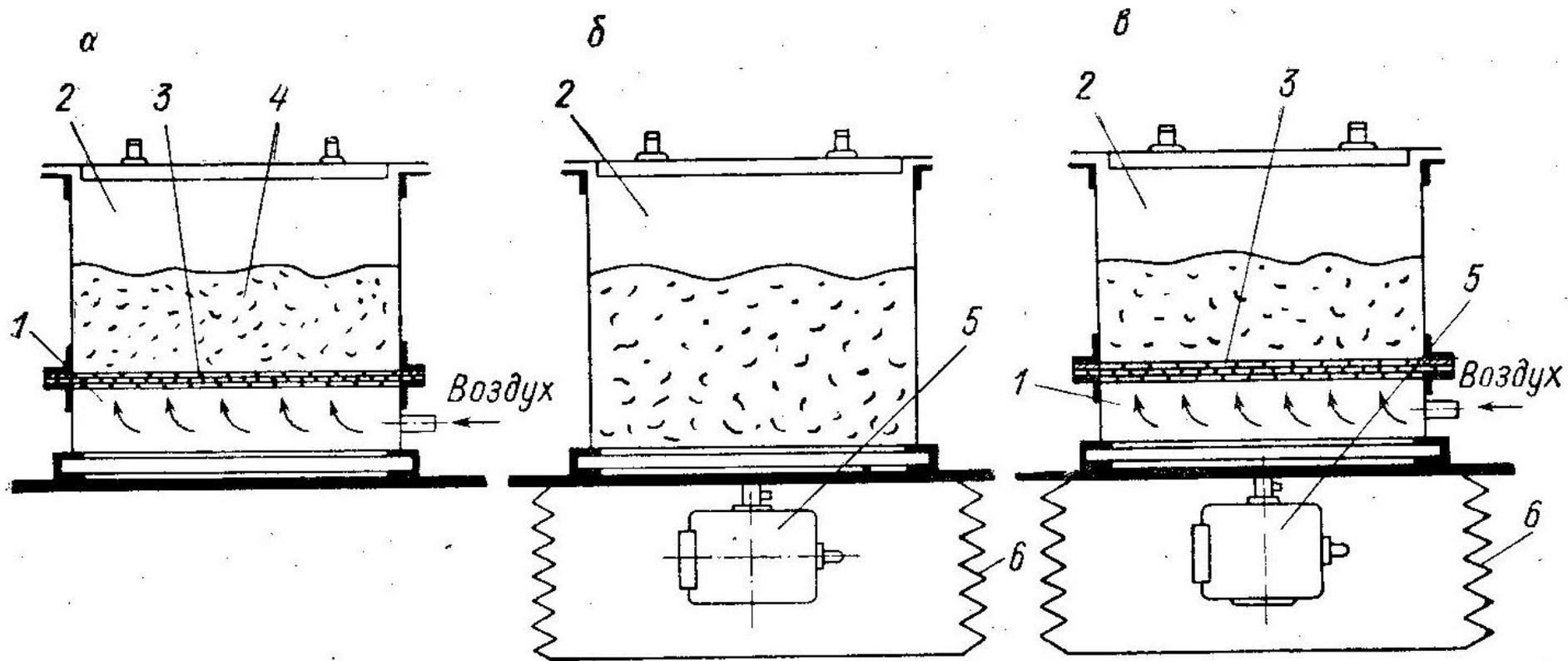
Схемы пневматического (*а*), вибрационного (*б*) и пневмовибрационного (*в*) аппаратов для вихревого напыления пластмасс:
