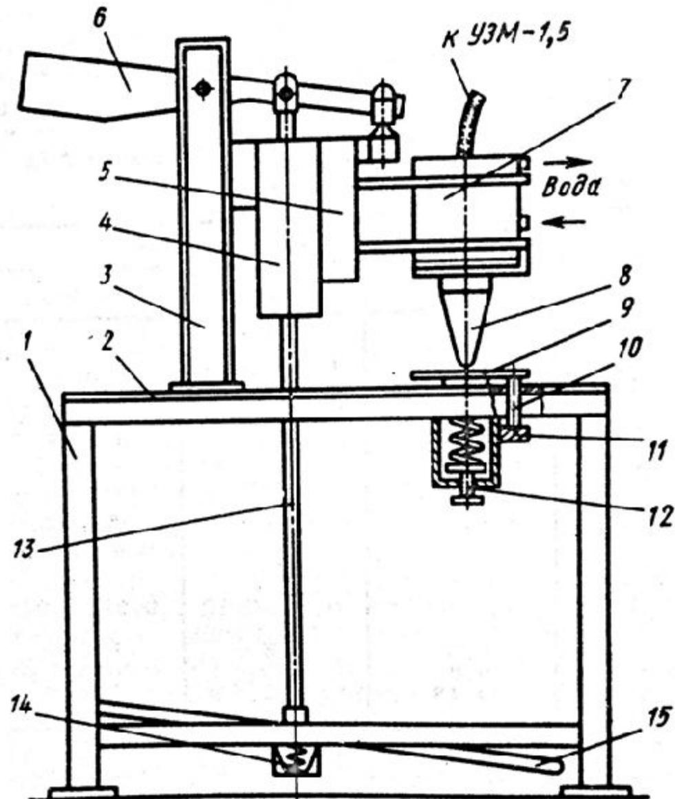
**Схема ультразвуковой сварочной установки УП-20**
