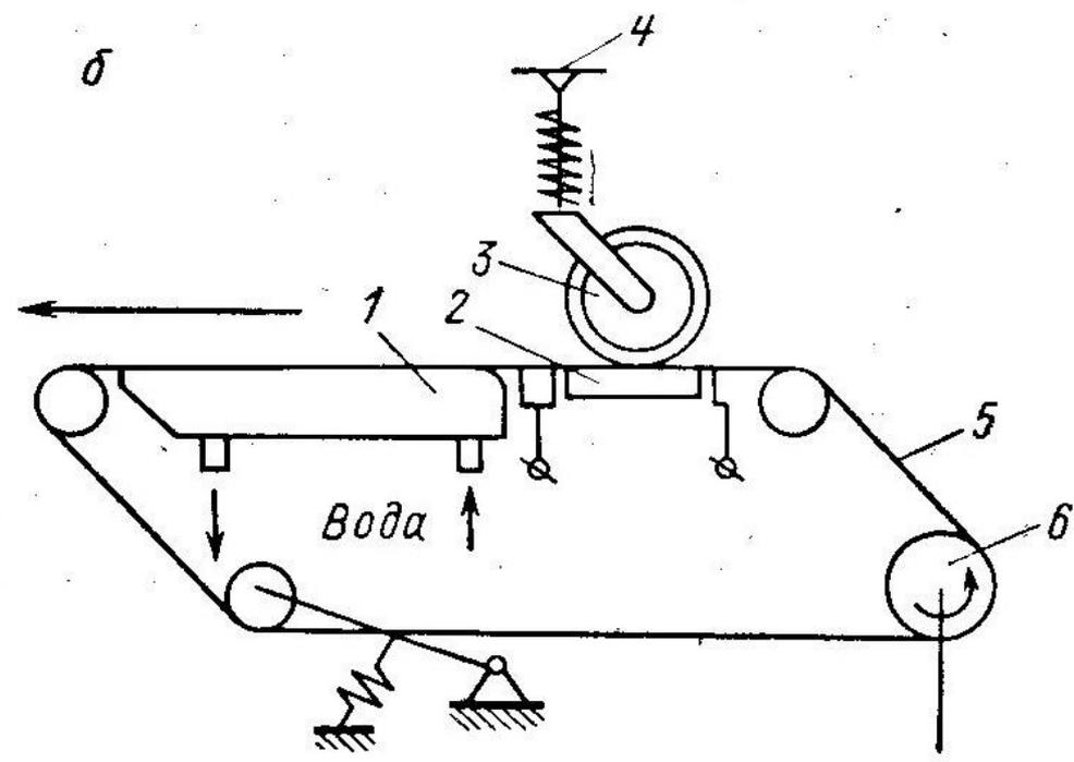
Машина для термоконтактной сварки пленок:
