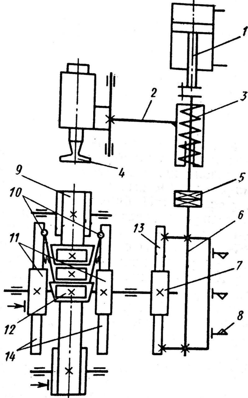
Кинематическая схема полу-автомата для ультразвуковой сварки катафотов
