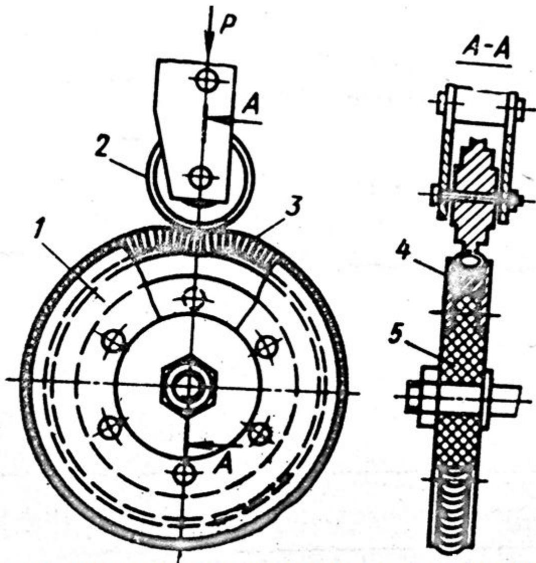
**Схема сварочного узла роликовой
