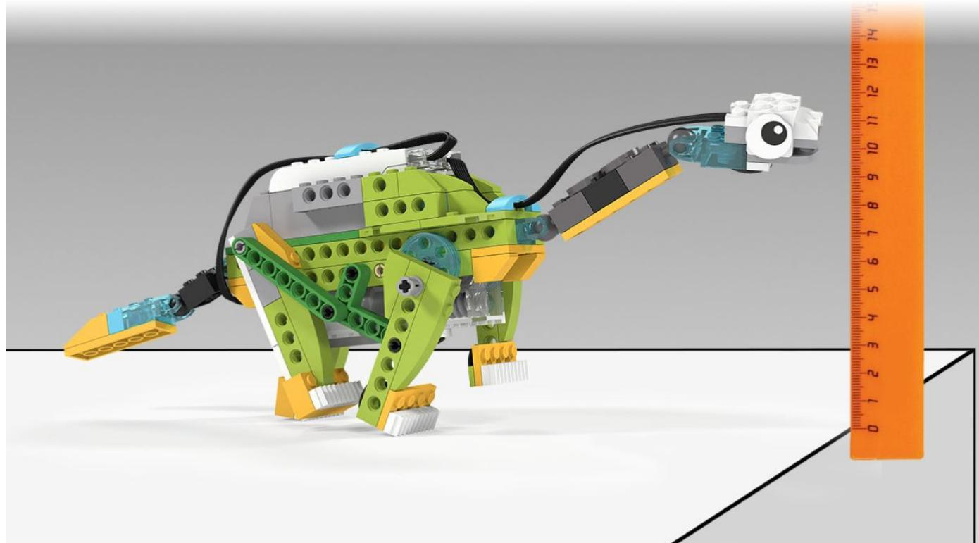
Завроподы были большими и медленными животными. А какую скорость может развивать ваш робот? Включите мотор на 60 секунд, посчитайте количество шагов, которое сделает робот и измерьте расстояние, которое он пройдет. Вместе с учителем рассчитайте скорость движения вашего робота.
