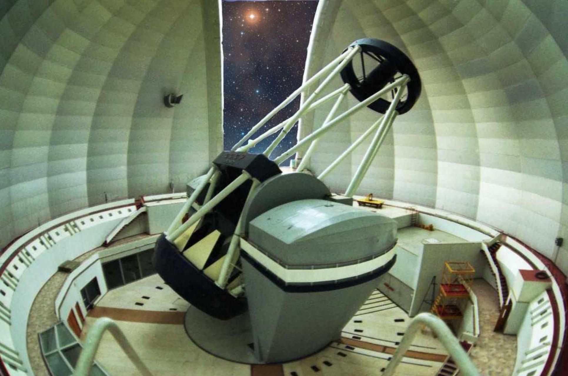
Современный крупный телескоп-рефлектор. Большой телескоп альт-азимутальный (БТА) диаметром 6 м Специальной астрофизической обсерватории (САО РАН). Северный Кавказ, станция Зеленчукская
