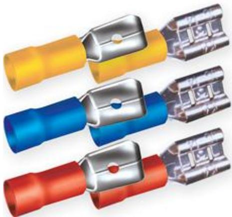
Разъемы плоские Рп (вилка/розетка) и разъемы штекеры Рш (вилка/розетка) предназначены для формирования изолированных разъемных соединений цепи по принципу «вилка/розетка». Разъёмы РпИо позволяет создать разъемное соединение с ответвлением от основной цепи. Цвет изоляции показывает соответствующую величину максимального тока (А) этого разъёма. На групповой и индивидуальной упаковке указывается типоразмер, что облегчает подбор необходимого разъема.
