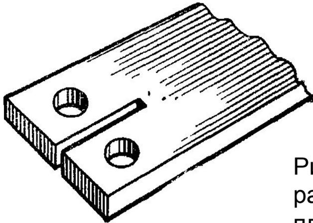
Рис. 5. Контактная деталь с продольным разрезом для болтового соединения с плоскими выводами
