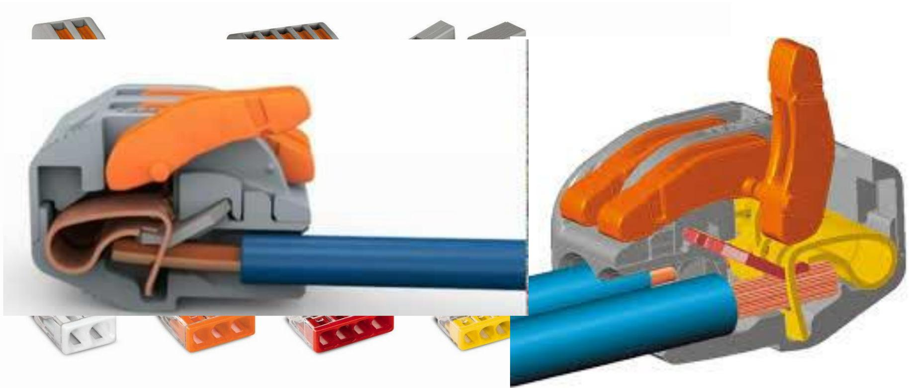
Для соединений проводов сечением 4 мм<sup>2</sup> и более, ответвлений от магистралей проводов хорошо подходят плашечные сжимы - "орешки".
