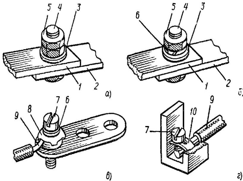
Рис. 1. Разборные контактные соединения с плоскими выводами без средств стабилизации электрического сопротивления
