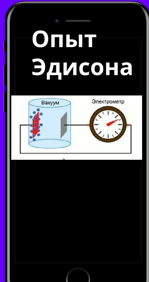
Результат опыта объясняется следующим образом: в результате нагревания металл из своей атомной структуры начинает испускать электроны, по аналогии испускания молекул воды при испарении. Разогретый металл окружает электронное облако. Такое явление называется термоэлектронной эмиссией.
