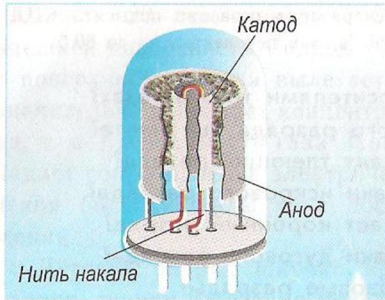
Рис. 1 Вакуумный диод
