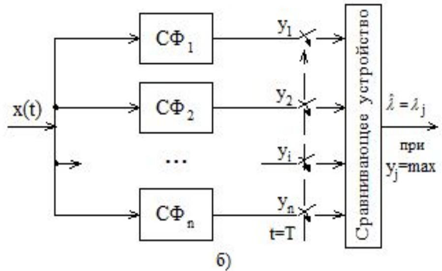
Рис. 5.4. Структурные схемы измерителей неэнергетических параметров сигнала
