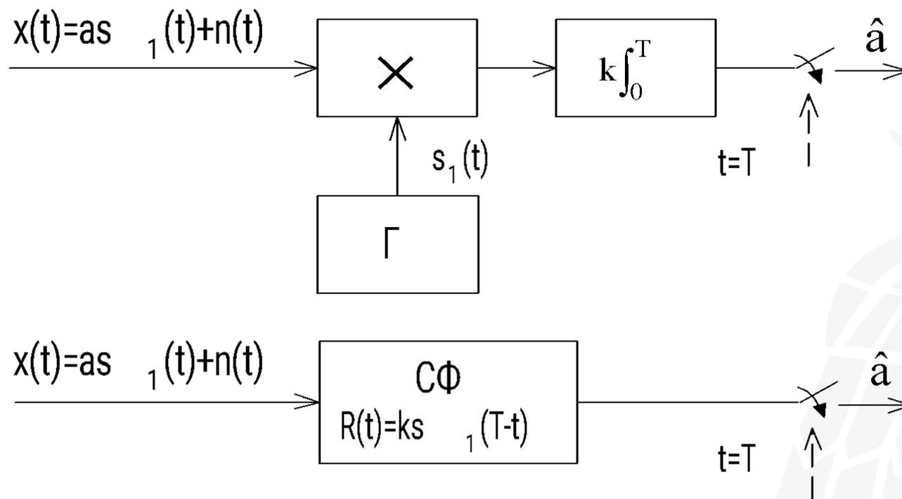
Рис. 5.3. Структурные схемы измерителей амплитуды сигнала
