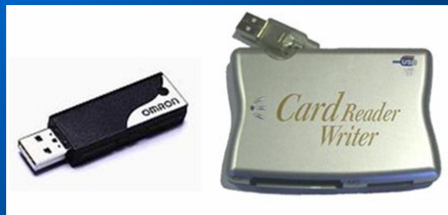
Флэш-накопитель (картридер) и USB-флэш-память (так называемые USB-«ключи» ).
