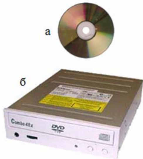
Привод накопителя на оптическом диске а – CD; б – CD/DVD привод
