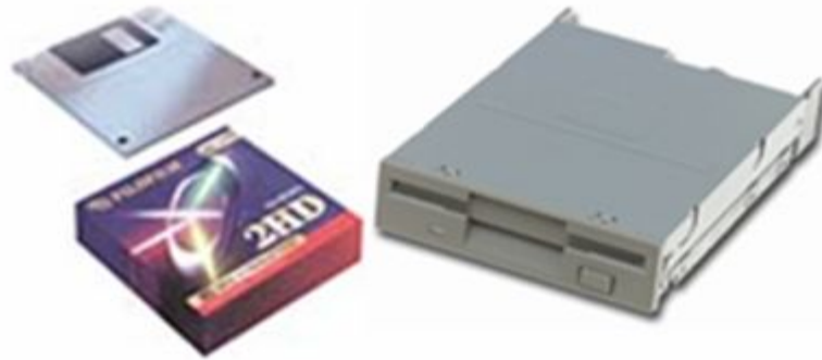
Накопители на дискетах (FDD – Floppy Disk Drive ФЛОППИ-ДИСКОВОД)
