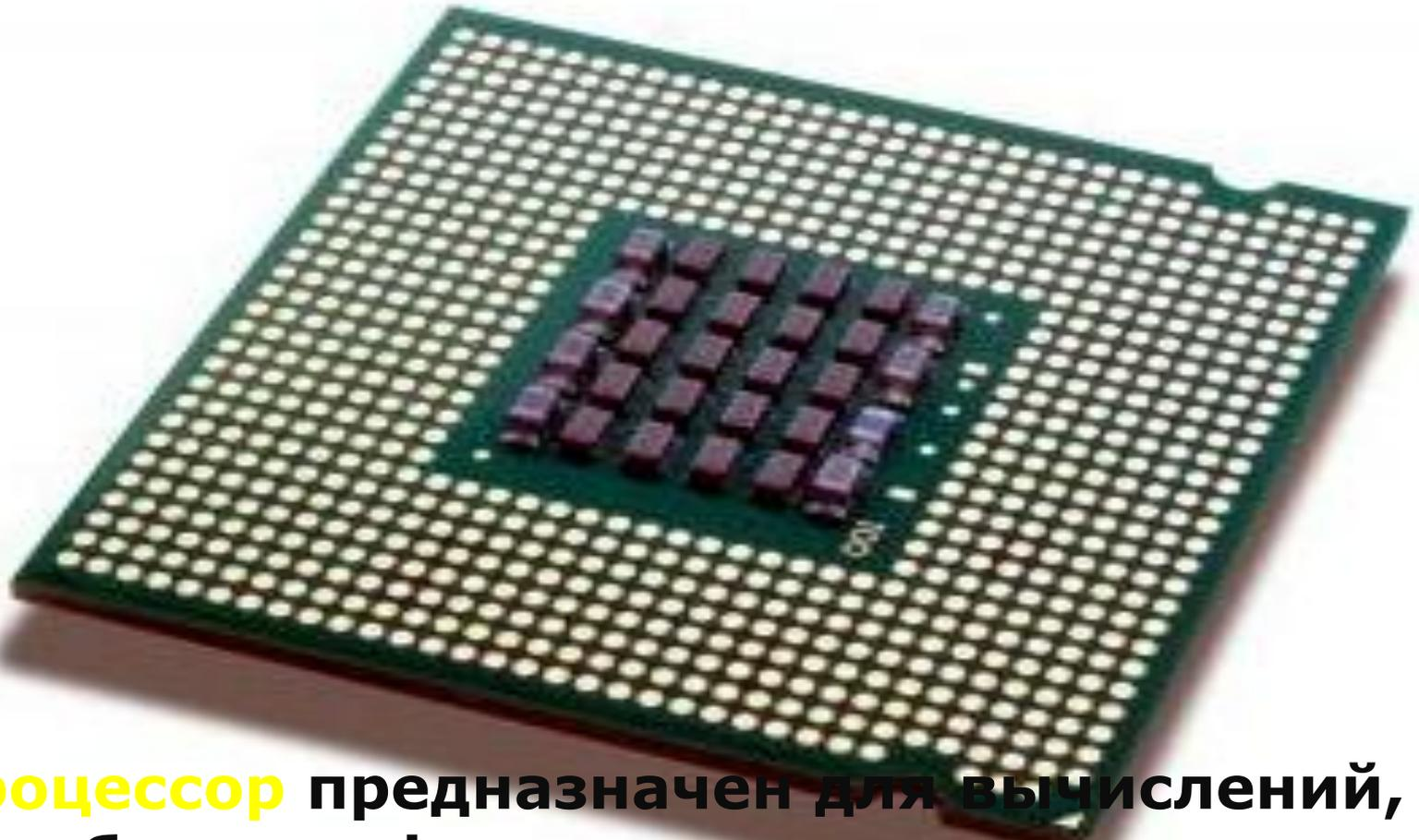
**Процессор** предназначен для вычислений, обработки информации и управления работой компьютера.
