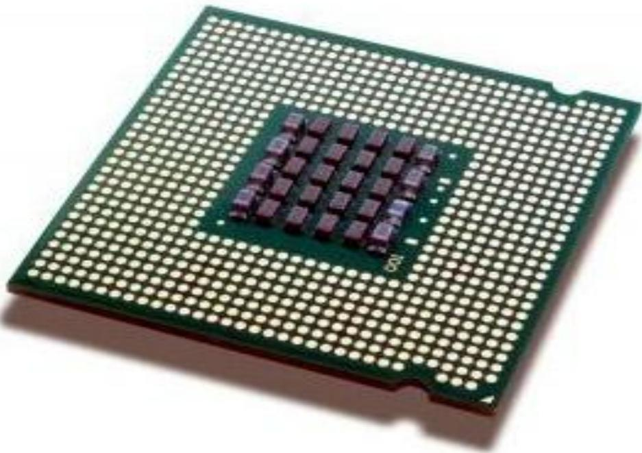
Аппаратно реализуется на большой интегральной схеме (БИС), размером 20 x 20 мм
