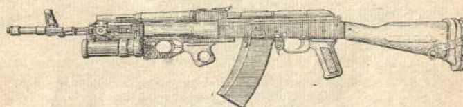
Рис. 3. Общий вид гранатомета, присоединенного к автомату АК74
