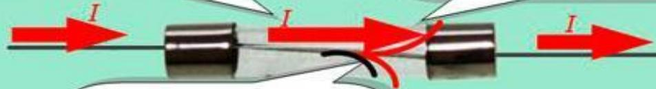
Металл проводника плавится, закипает и разрывает цепь
