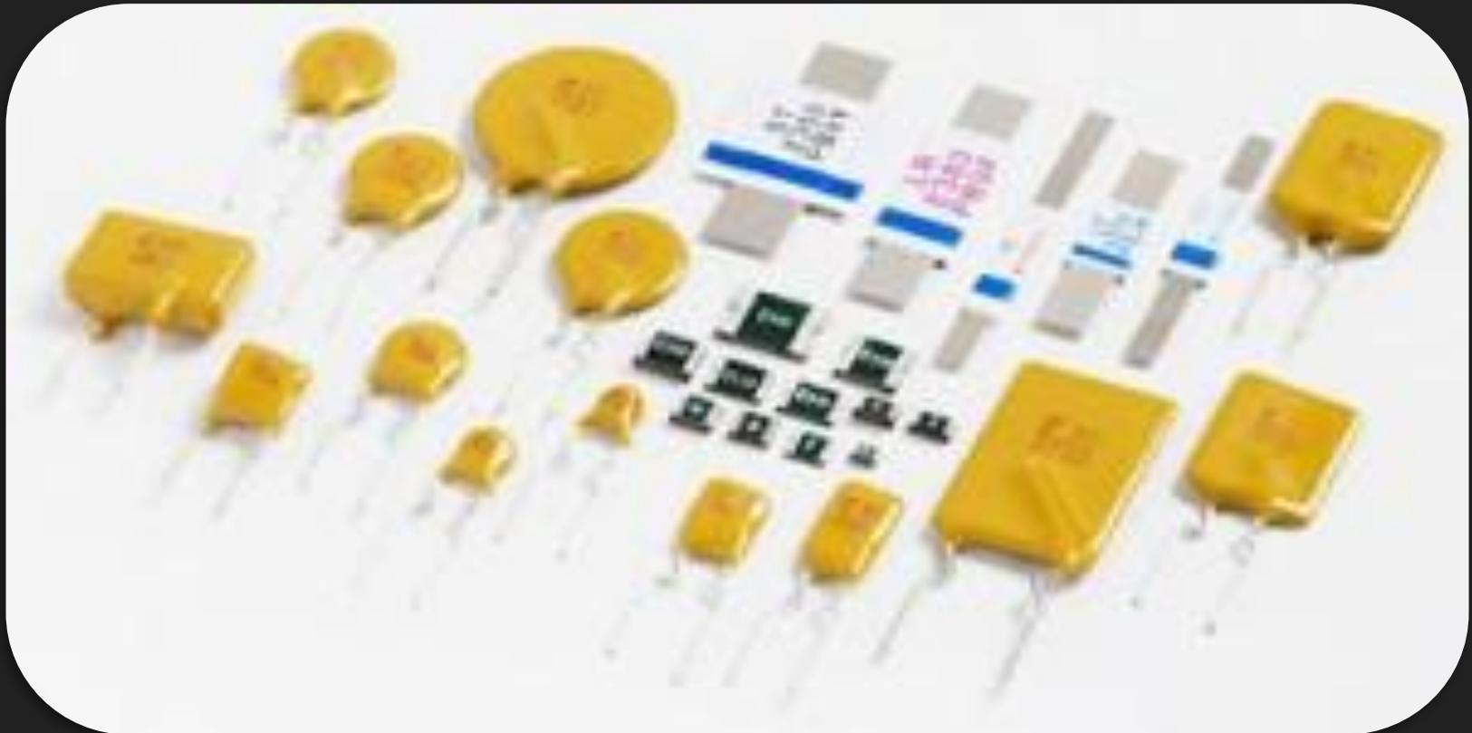
За основу конструкции взяты полимерные материалы, обладающие положительным температурным коэффициентом для электрического сопротивления. Они обладают кристаллической структурой решетки при обычных, нормальных условиях и **резко переходят в аморфное состояние при нагреве.**
