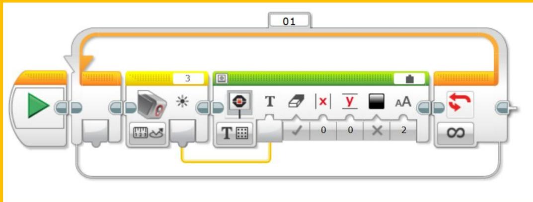
На экране микроконтроллера постоянно будут выводиться показания датчика.
