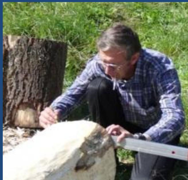
В первый день мы разметили бревно и начали вырубать, выбирать объём. Если раньше всё, от начала до конца, делалось вручную, с помощью тёсел - специальных топоров, то у нас, кроме них, на вооружении была бензопила «Штиль-360», которой орудовали там, где только возможно, но основная работа делалась всё-таки тёслами.
