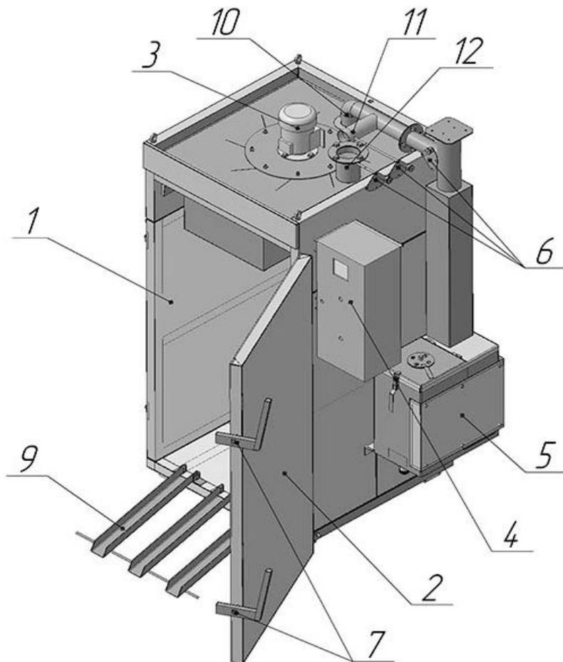
Камера термодымовая электрическая предназначена для горячего копчения мяса и рыбопродуктов в технологической среде, представляющей собой смесь воздуха, горячего или холодного дыма и паров воды.
