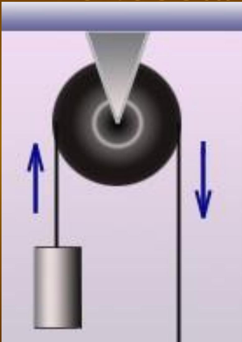
Неподвижный блок — это блок, ось которого закреплена и при подъеме грузов не поднимается и не опускается.
