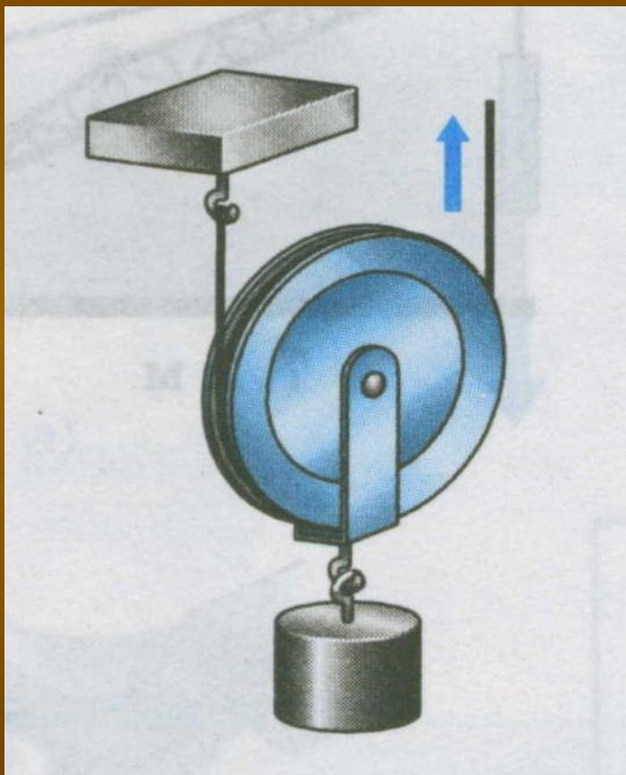
Подвижный блок — это блок, ось которого поднимается и опускается вместе с грузом. Он дает выигрыш силы в **2** раза.
