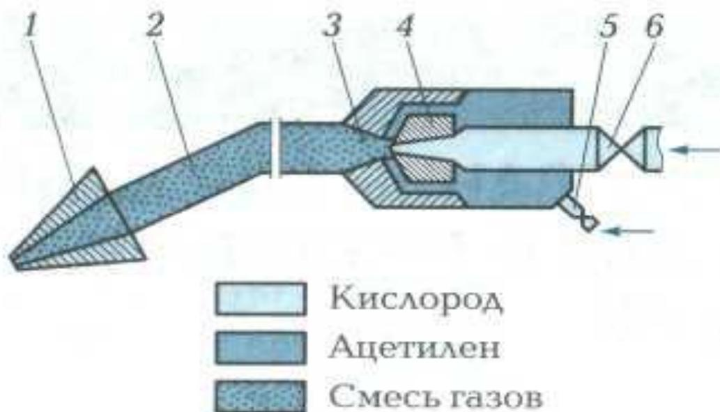
Принцип действия газосварочной инжекторной горелки:
