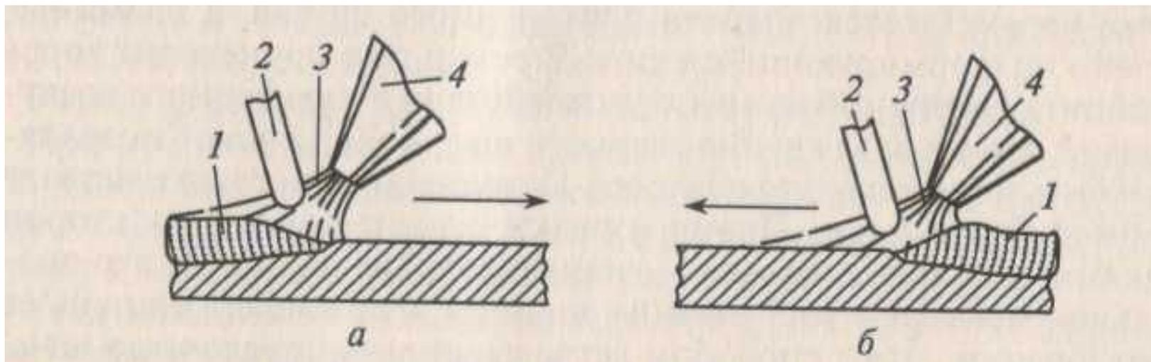
**Левый (б)** - пламя направляется на несваренные кромки и подогревает их, подготавливая к сварке.
