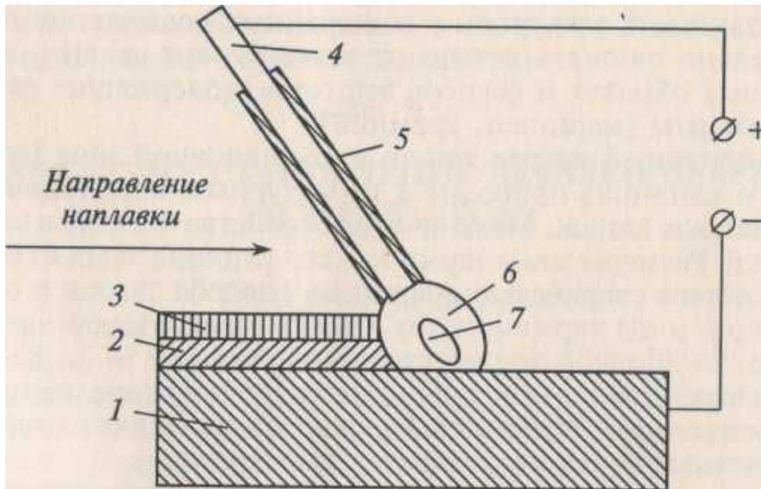
Схема ручной наплавки:
