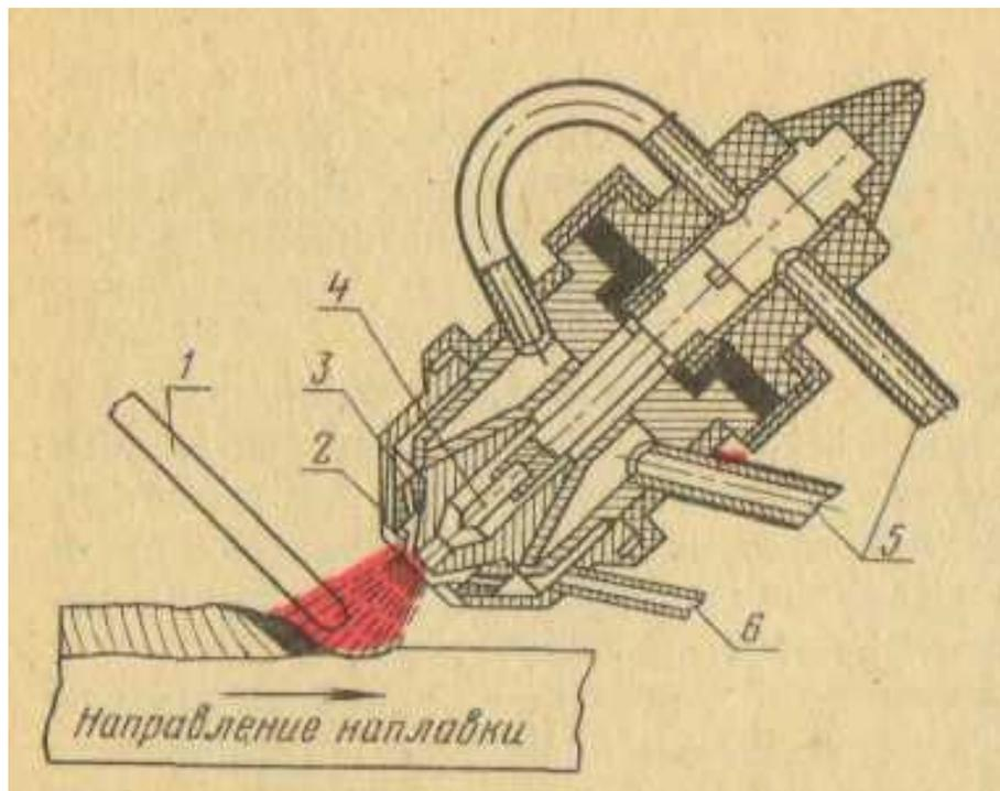
Плазменная горелка и схема наплавки прутками твердых сплавов или проволокой:
