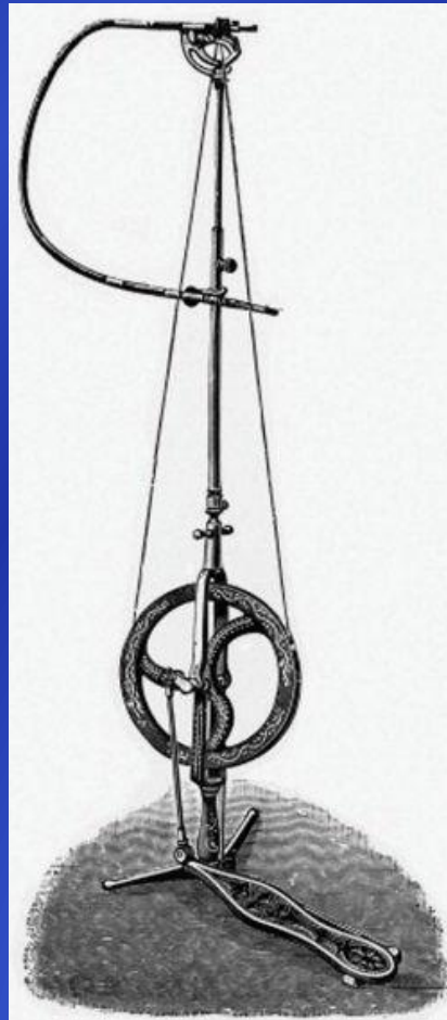
Первая бормашина с ножным приводом
