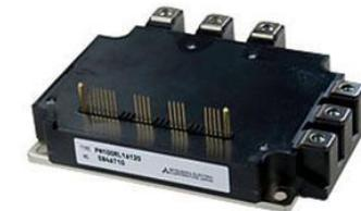
Отличаются высоким быстродействием, высокими значениями коммутируемых токов и напряжений, малыми коммутативными потерями и малой мощностью управления.
