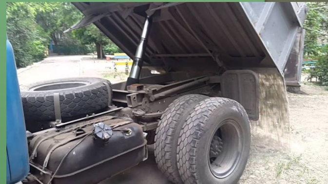
гидравлический подъёмник кузова автомобиля
