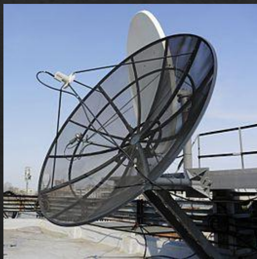
Прямофокусная антенна для приёма спутникового ТВ с зеркалом из металлической сетки
