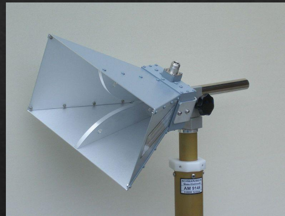
Широкополосная измерительная рупорная антенна на частоты 0,8—18 ГГц
