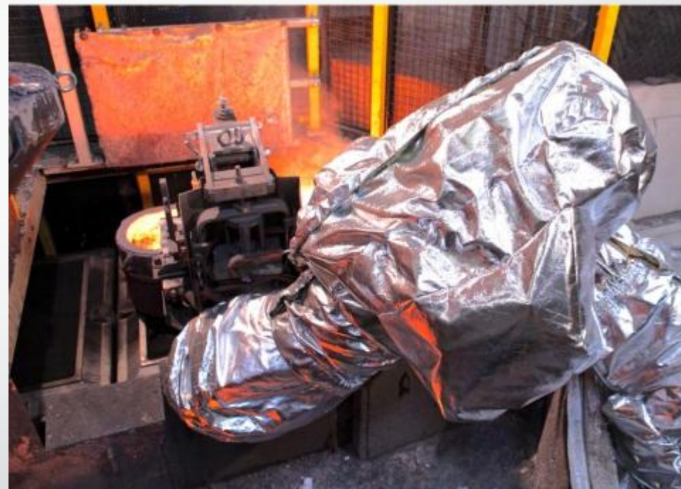
Робот на линии отливки расплавленного железа
