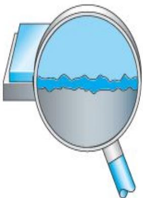
При наличии смазки соприкасаются не сами поверхности тел, а ее соседние слои. Трение между слоями жидкости слабее, чем между твердыми поверхностями.
