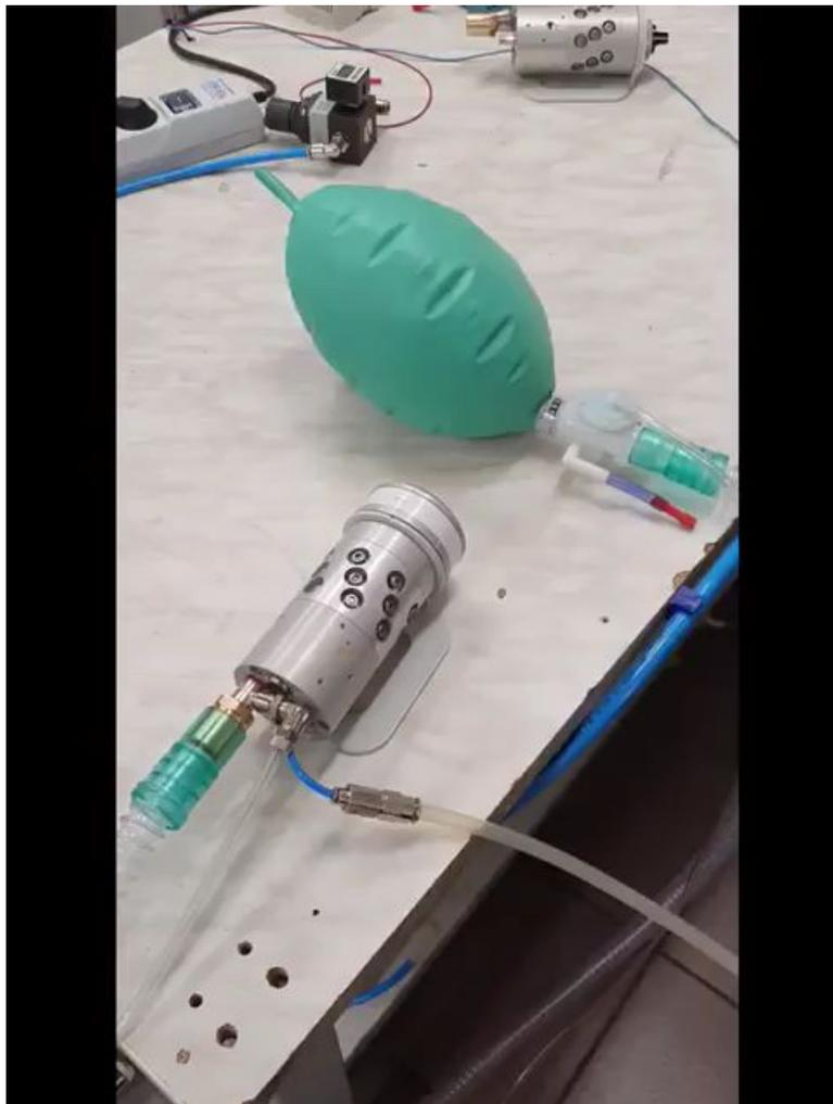
На видео слева представлена работа генератора импульсов для пневматического ИВЛ с семью режимами.
