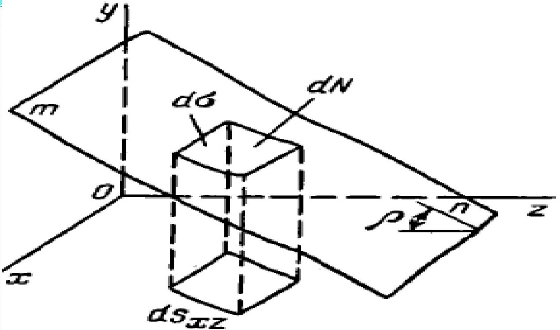
Рисунок 3.4 – Схема определения проекции элементарной нагрузки на оси координат
