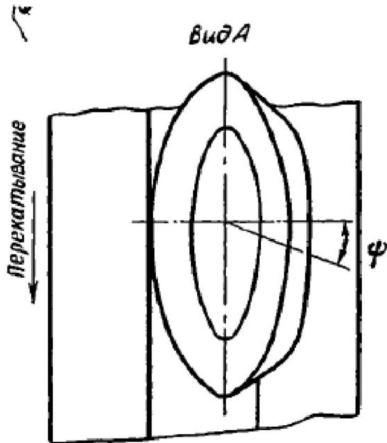
Рисунок 3.8 Углы, характеризующие установку шарошек на исполнительном органе
