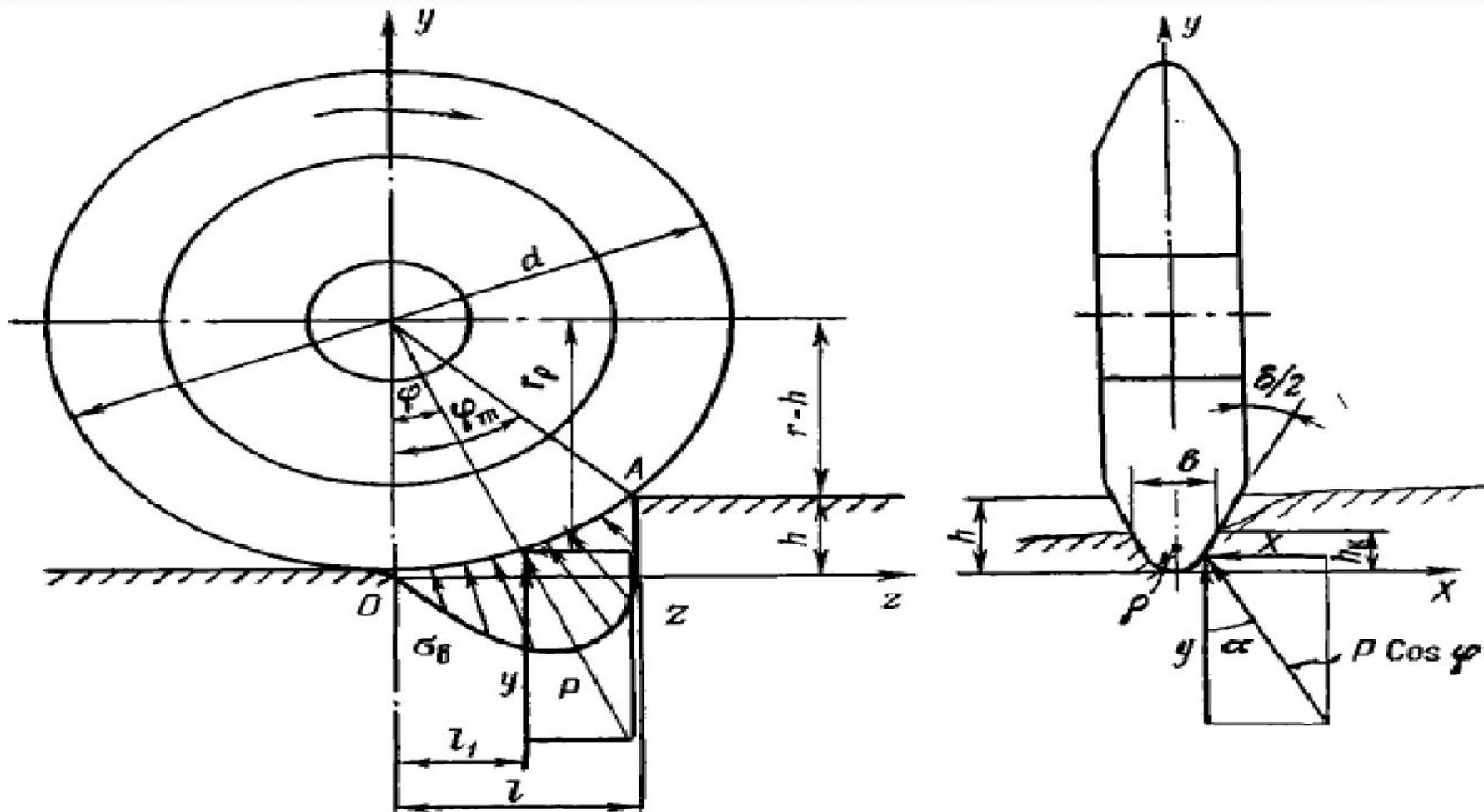
Рисунок 3.10 - Схема сил на лобовой дисковой шарошке
