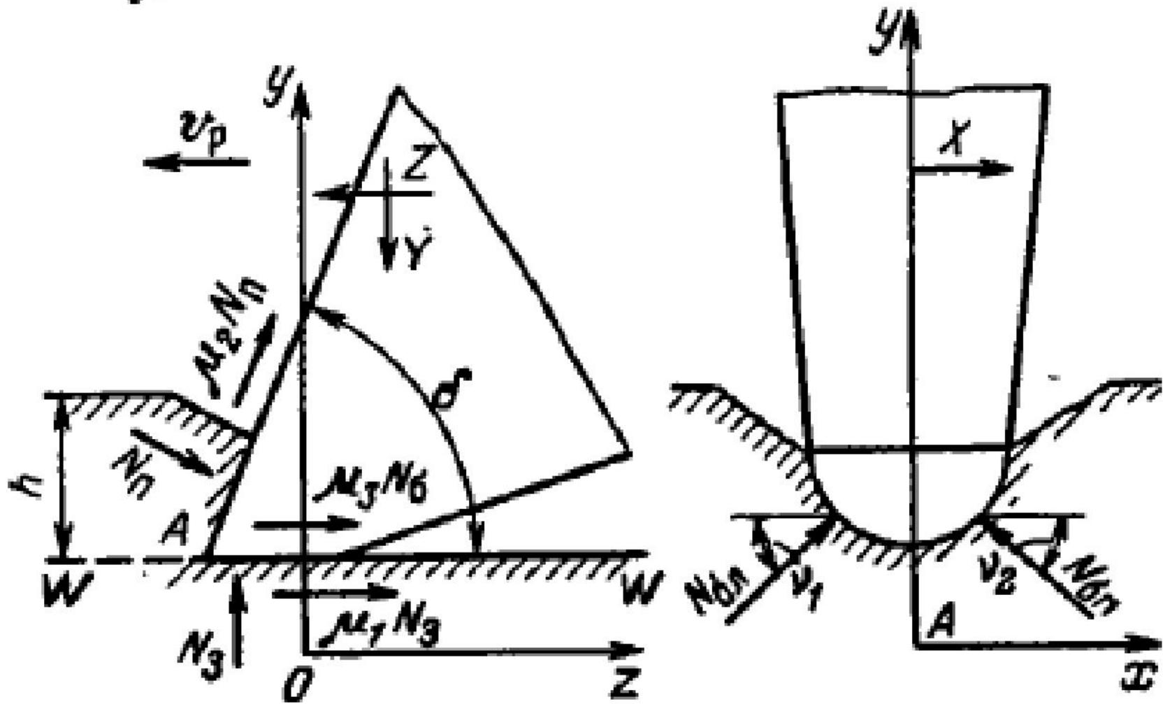
Рисунок 3.3 – Схема сил на резце
