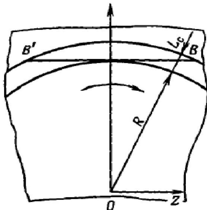
Рисунок 3.9 Схема к определению пути скольжения диска шарошки относительно породы
