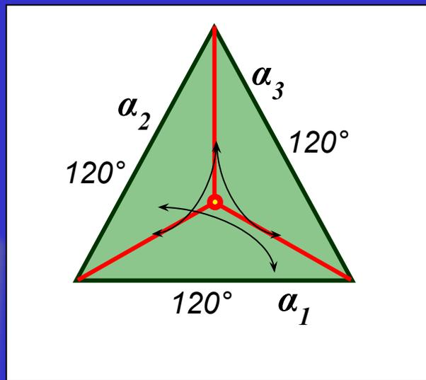
Проекции координатных осей на картинную плоскость – **аксонометрические оси** образуют углы  $360^\circ/3 = 120^\circ$
