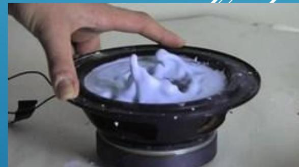
Течение бингамовских жидкостей начинается только после создания определённого напряжения  $\tau_0$ , называемого начальным напряжением сдвига. При меньших, чем  $\tau_0$ , напряжениях такие жидкости ведут себя, как твёрдые тела, а при больших – как ньютоновская жидкость, для которой напряжение сдвига равно  $\tau - \tau_0$
